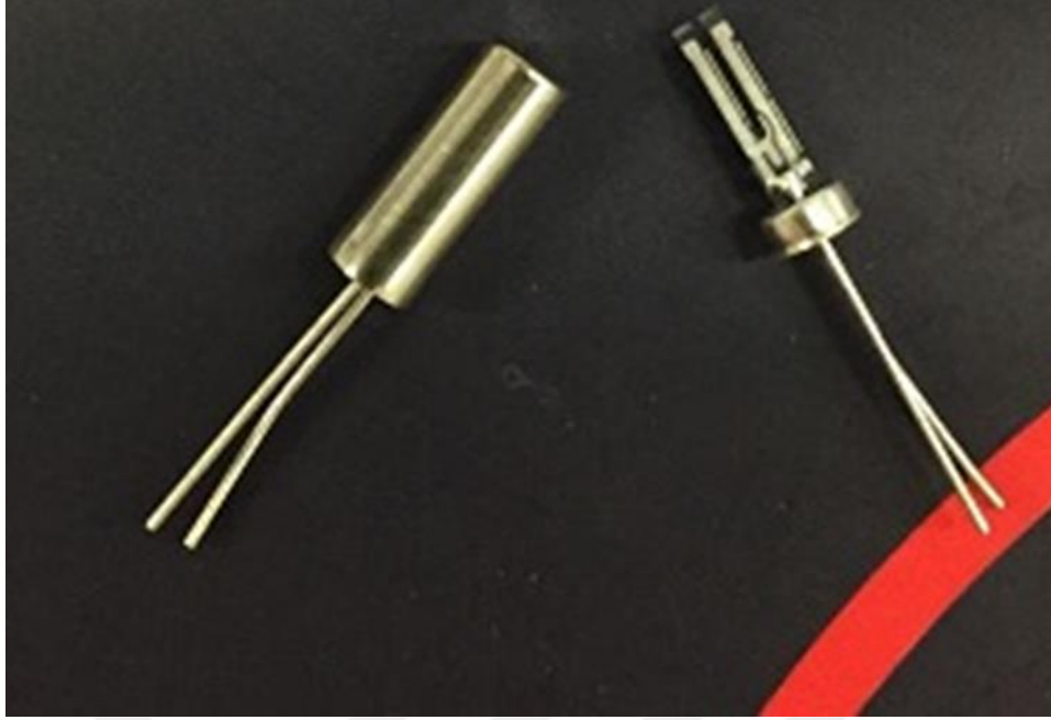
Şekil 2.2 : QTF'lerin vakumlu (solda) ve dekapsüle (sağda) haldeki görüntüleri
