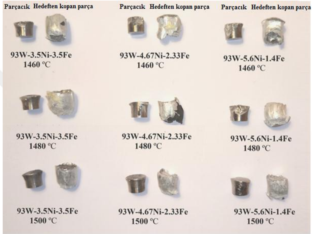
Şekil 5.16 : Balistik testler sonrası 93W-3.5Ni-3.5Fe, 93W-4.67Ni-2.33Fe ve 93W-5.6Ni-1.4Ni parçacıklarının ve hedeften koparılan parçaların görüntüsü.
