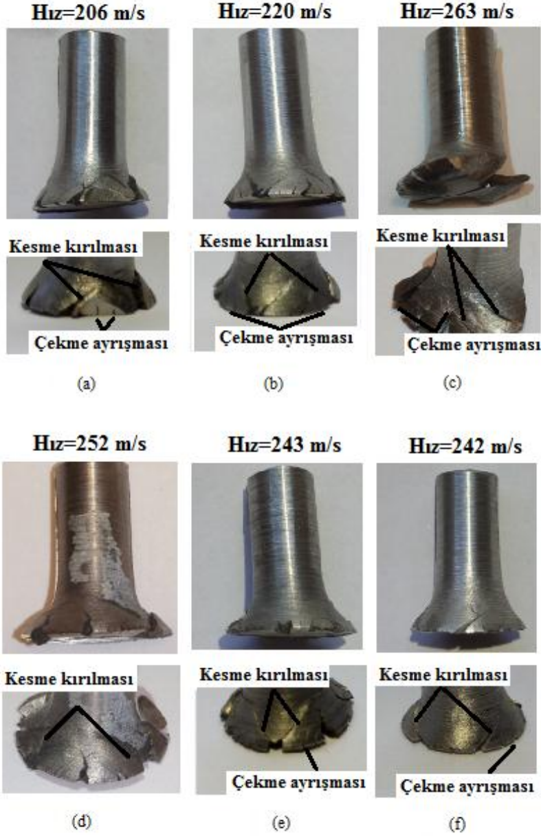
Şekil 5.13 : Taylor numunelerin çelik hedefe çarpması sonrasında çarpma yüzeylerinde oluşan kırılma biçimleri (a) 93W-3.5Ni-3.5Fe, sinterleme sıcaklığı 1480 °C (b) 93W-3.5Ni-3.5Fe, sinterleme sıcaklığı 1500 °C (c) 93W-4.67Ni-2.3Fe, sinterleme sıcaklığı 1480 °C (d) 93W-4.67Ni-2.3Fe, sinterleme sıcaklığı 1500 °C (e) 93W-5.6Ni-1.4Fe, sinterleme sıcaklığı 1480 °C (f) 93W-5.6Ni-1.4Fe, sinterleme sıcaklığı 1500 °C.
