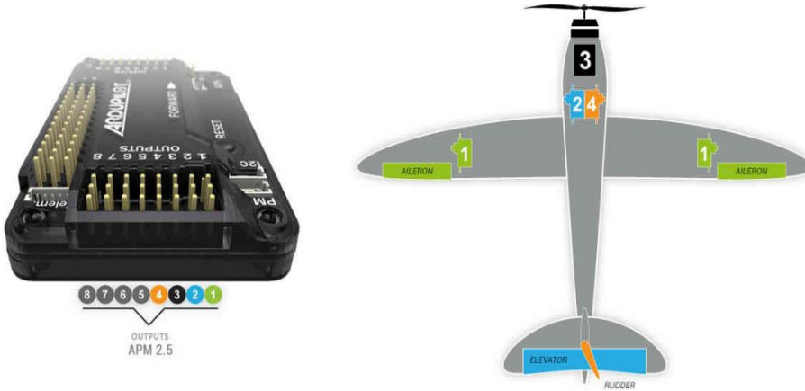
Şekil 4.21 : ArduPilot Mega 2.5 eyleyici-çıkış kanalı bağlantı şeması
