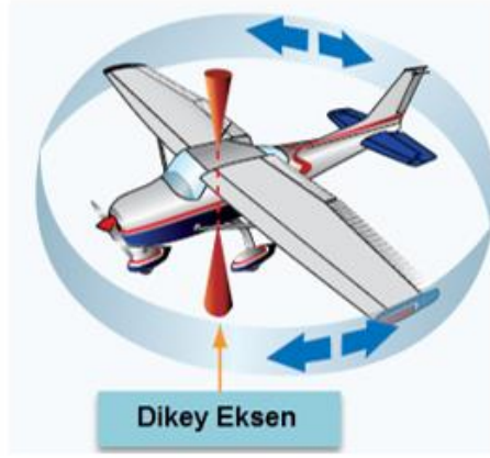
Şekil 3.11 : Dikey eksen ve bu eksendeki hareket
