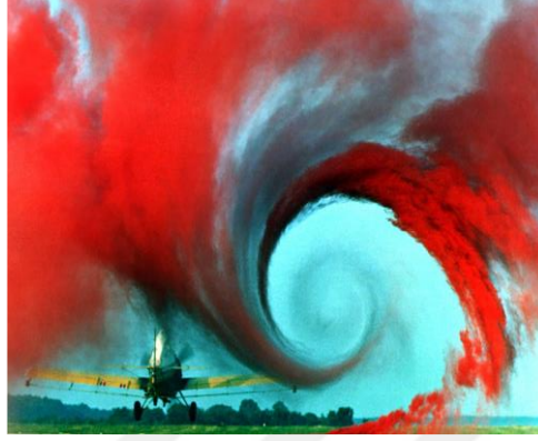
Şekil 3.7 : Kanat uç girdapları gerçek uçuş testi
