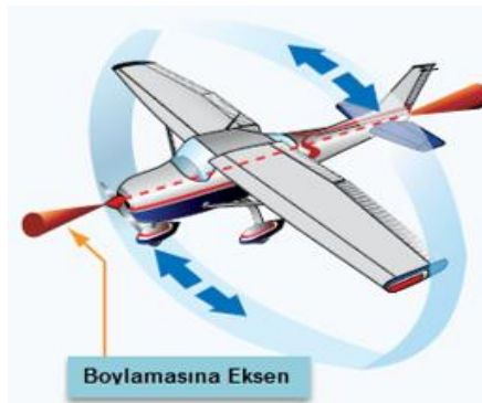
Şekil 3.10 : Boylamasına eksen ve bu eksenindeki hareket
