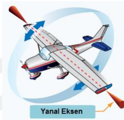
Şekil 3.9 : Yanal eksen ve bu eksenindeki hareket
