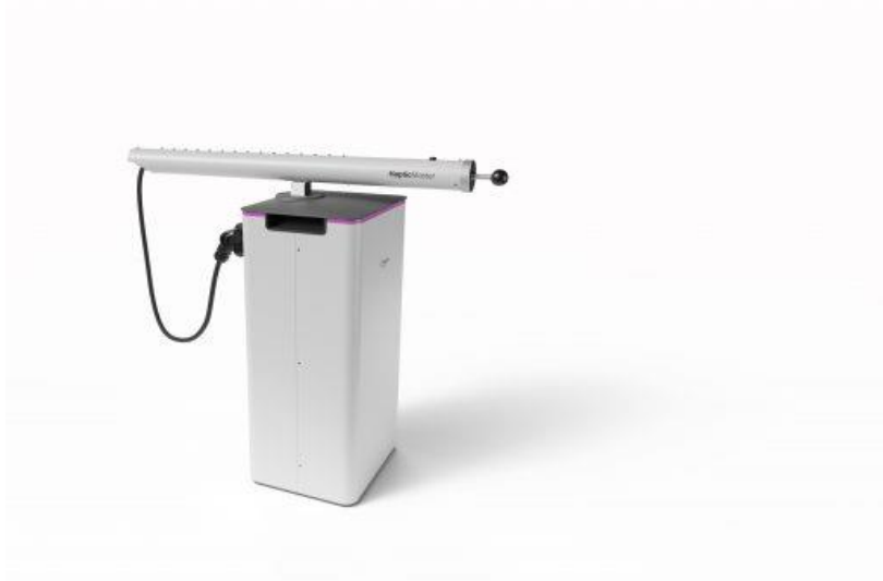
Resim 1.3 : Admitans tipi haptik cihaz "Haptic Master" [10]
