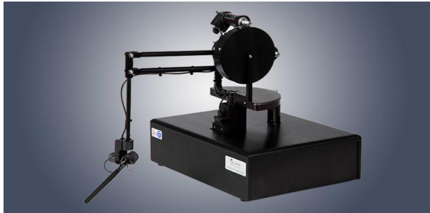
Resim 1.2 : Empedans tipi haptik cihaz “Phantom Premium” [8]
