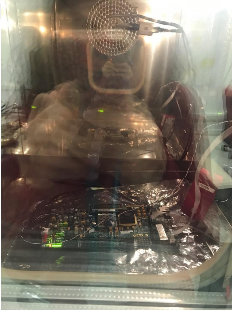
Şekil 4.3 : Sıcaklık kabini içerisindeki FPGA geliştirme kartı.
