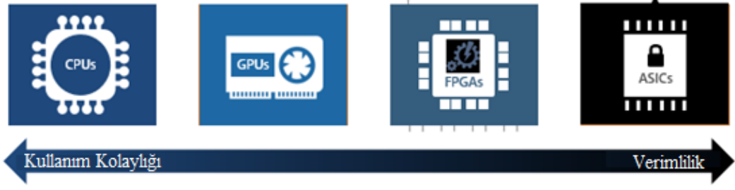
Şekil 2.3 : CPU, GPU, FPGA ve ASIC karşılaştırması [12].
