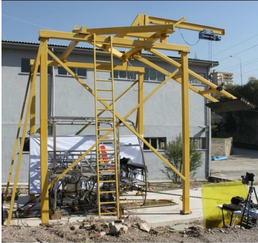
Şekil 5.1 : ECE R-29 yönetmeliğine uygun önden çarpışma test düzeneği [45]
