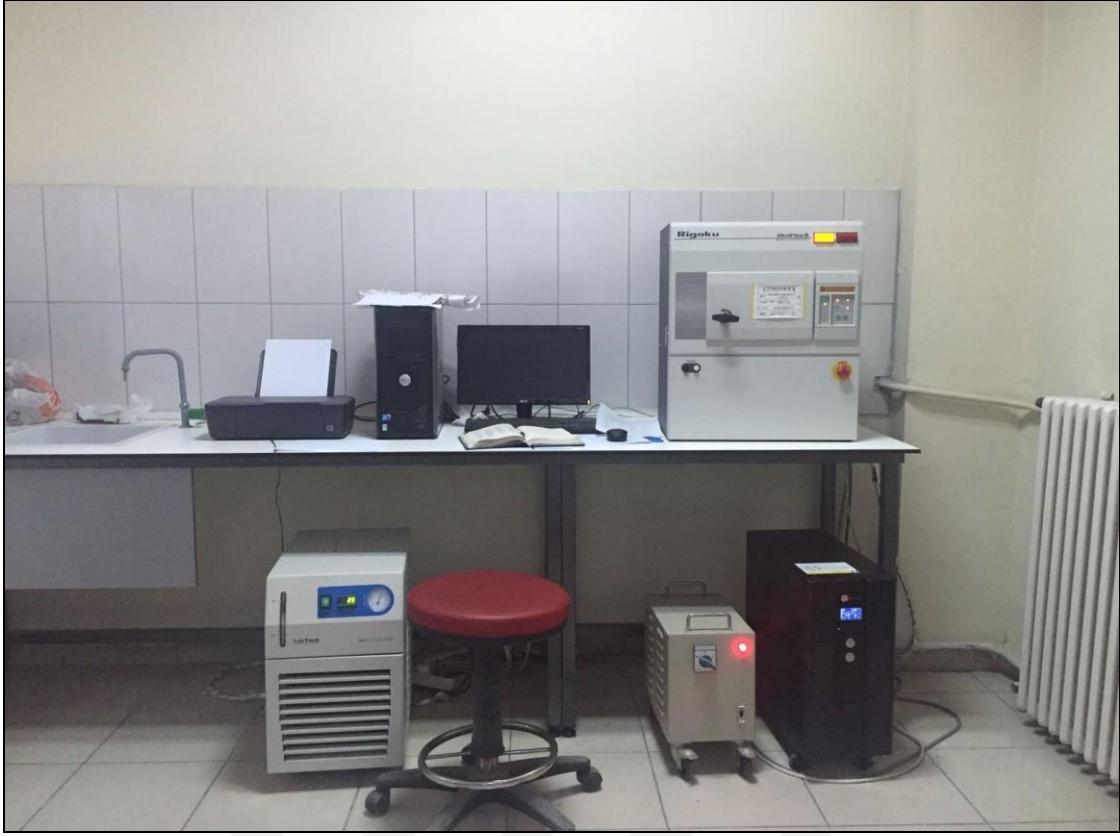
Şekil 2.3. Batman Üniversitesi Jeoloji Mühendisliği Laboratuvarı'nda mineralojik incelemelerde kullanılan Rigaku marka Miniflex II model XRD analiz cihazı
