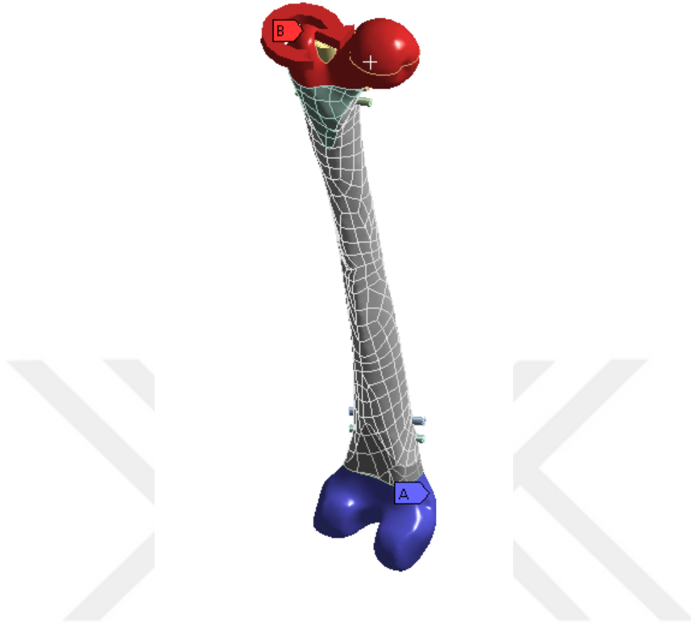
Şekil 2.13: Burma testi sınır koşulları.
