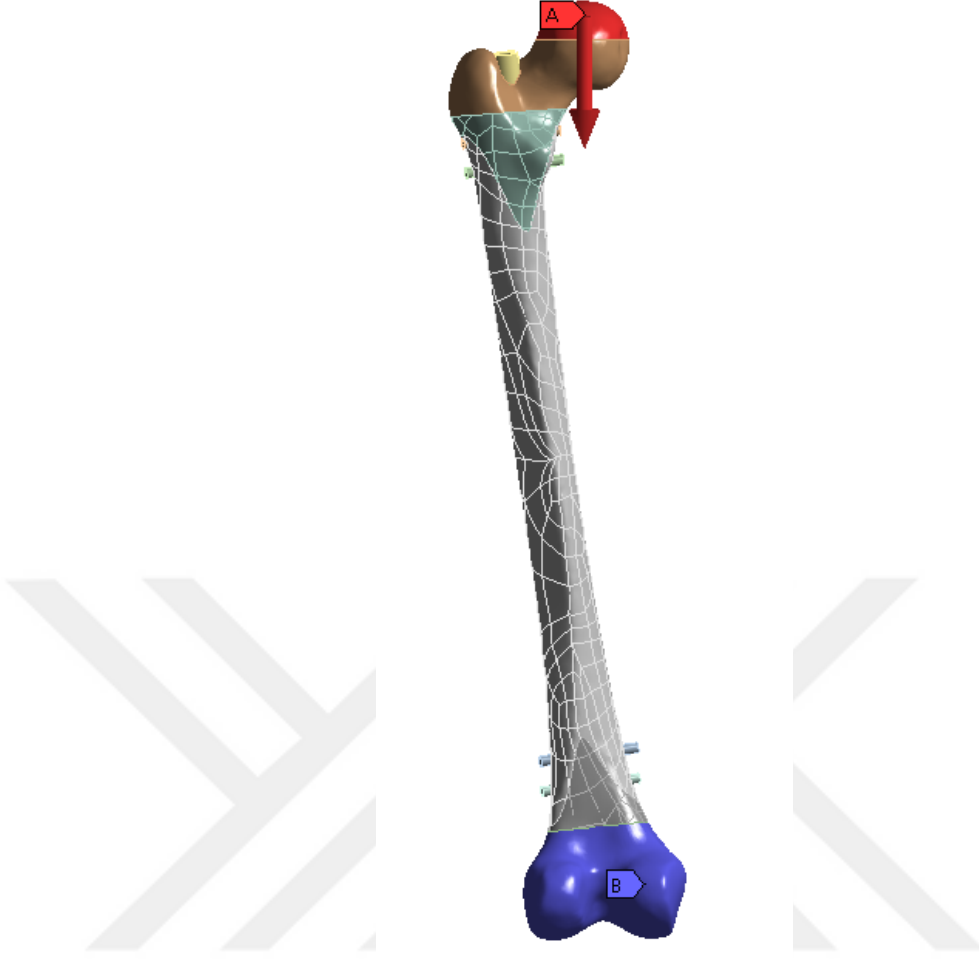
Şekil 2.12: Eksenel basma testi sınır koşulları.
