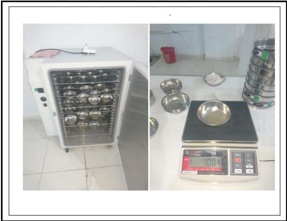
Şekil 4.3. Etüv kurutma yöntemi ile su içeriği belirlenmesi.
