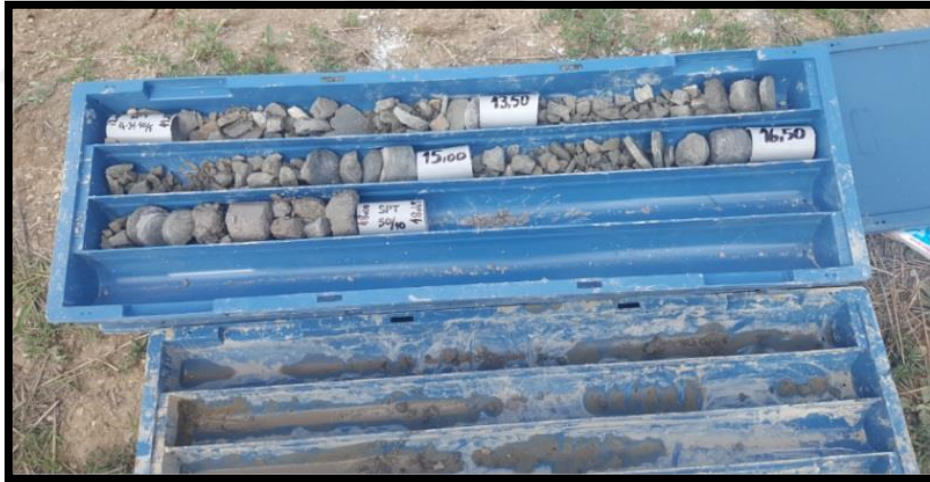
Şekil 4.8. İnceleme alanındaki sondaj kuyularından alınan karot numuneleri
