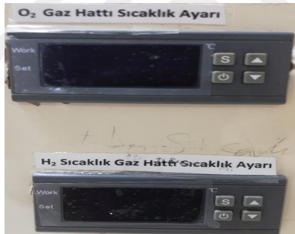
Şekil 4. 8. PEMYP Sisteminde Kullanılan Oksijen ve Hidrojen Sıcaklık Ayar Rölesi
