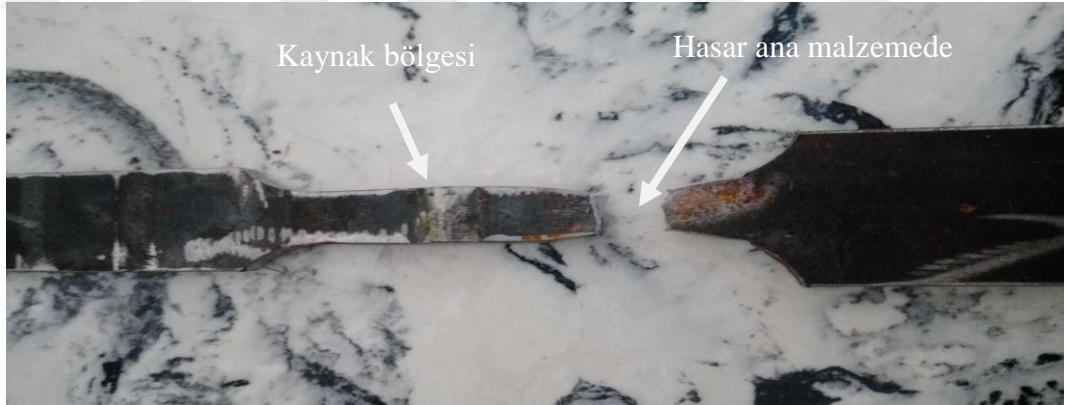
Şekil 4.21 T2-saf hasarlı numune
