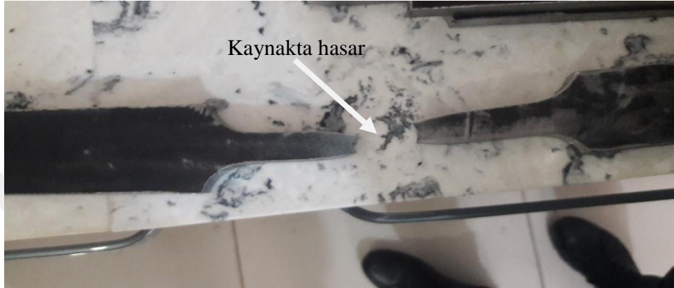
Şekil 4.19 T1 saf kaynak metalinin hasarlı numunesi
