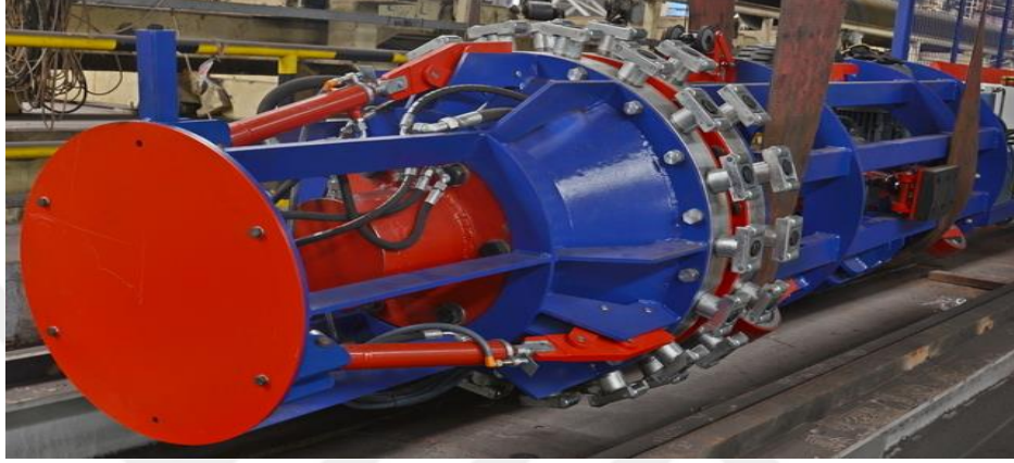
Şekil 2.6 Kaynak dikişinin merkezlenme tertibatı (Planteknik, 2019)
