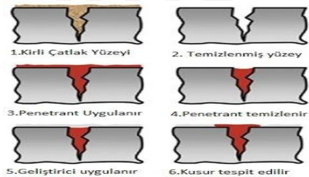
Şekil 3.13 Penetrant Uygulama Şeması (Enkon, 2018)
