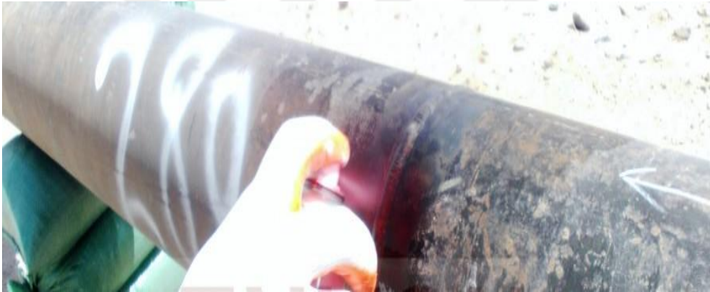
Şekil 3.12 Penetran sıvı ve floresant (Enkon, 2018)
