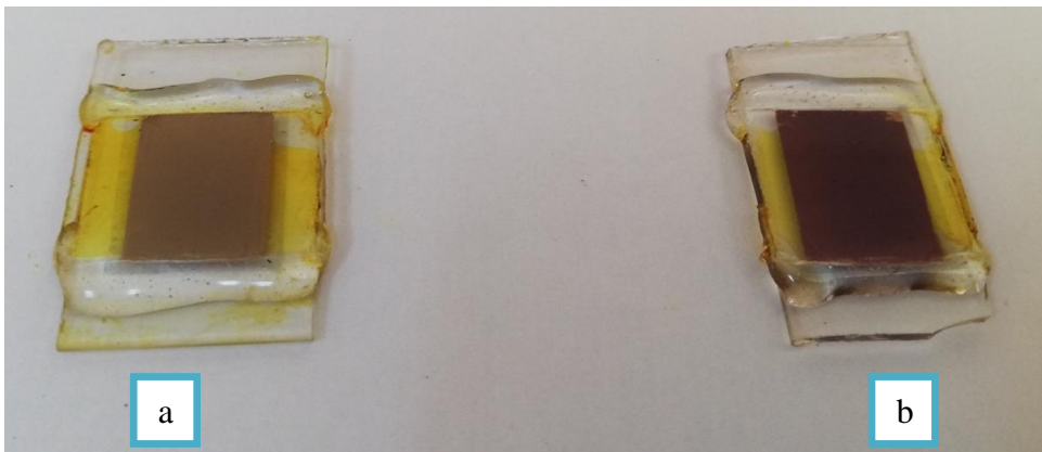
Şekil 3.14. a) Quercetin Cu(II) Kompleksi kullanılarak hazırlanmış güneş pili, b) N3 boya kullanılarak hazırlanmış güneş pili
