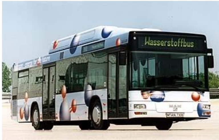
Şekil 3.5.2. Hidrojenle çalışan bir otobüs (MAN NL 193 CGH 2 ) ( www.H2cars.de 2001).
