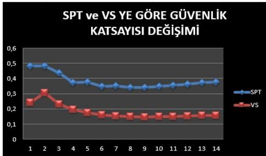
Şekil 5.23. M=7.5 ve a=0.40 g lik ivme için yeraltı suyunun 1 metrede olduğu durum için, SPT ve Kayma Dalga Hızı Vs na göre GK (Güvenlik katsayısının) değişimi
