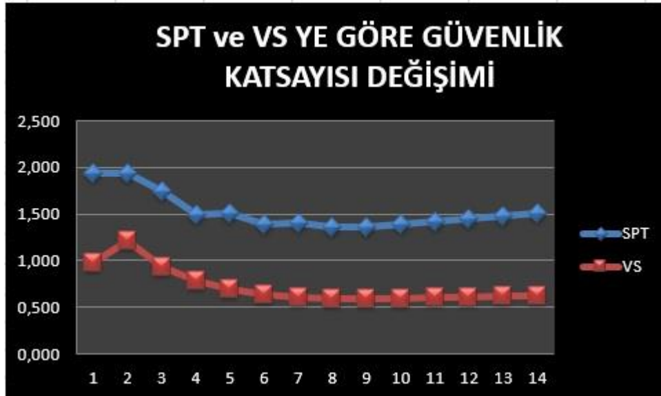
Şekil 5.11. M=7.5 ve a=0.10 g lik ivme için yeraltı suyunun 1 metrede olduğu durum için, SPT ve Kayma Dalga Hızı Vs na göre GK (Güvenlik katsayısının) değişimi
