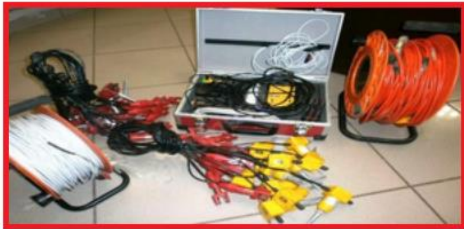
Şekil 4.33. Seismic Source firmasının 12 Kanallı SARA DO-RE-Mİ sismik ölçüm ekipmanı
