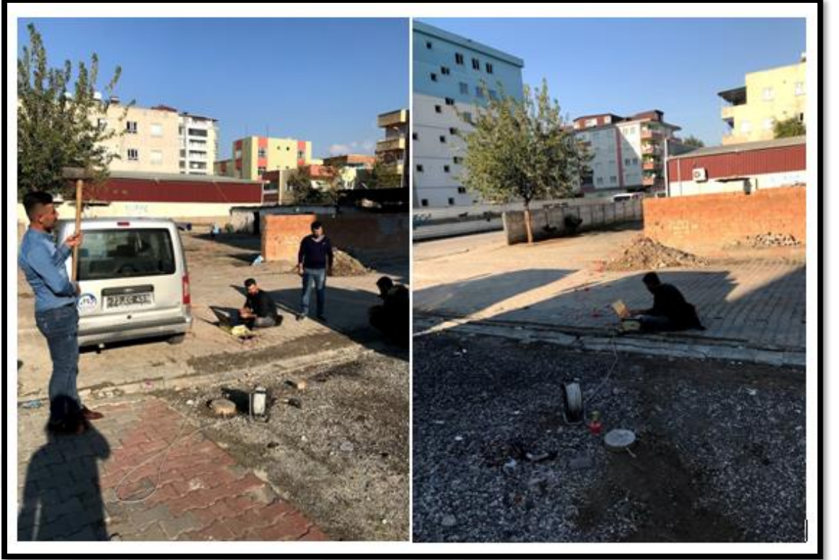
Şekil 4.31. İnceleme alanında yapılan sismik yöntem ölçüm çalışmaları
