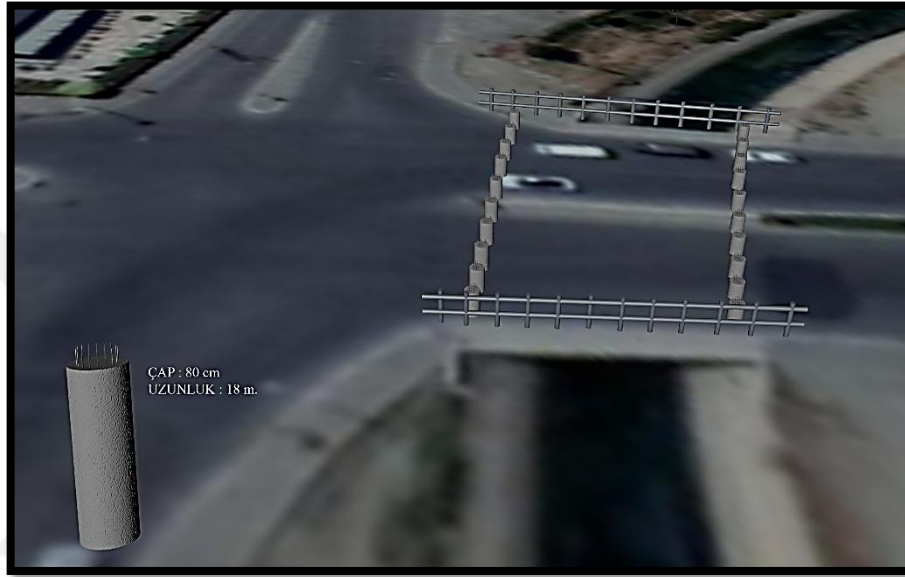
Şekil 5.20. İnceleme alanındaki Fore Kazık çalışmasının üç boyutlu görünümü.
