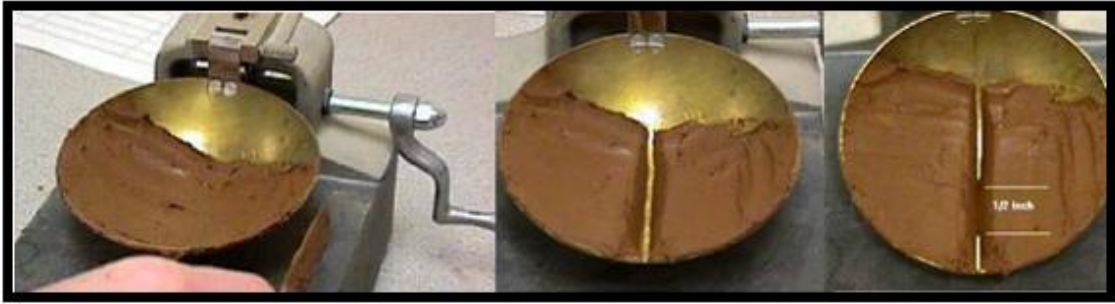
Şekil 4.3. Likit limit deney (Casagrande) aleti (ASTM 4318 http://www.soiltest.com.tr/laboratuvar ).
