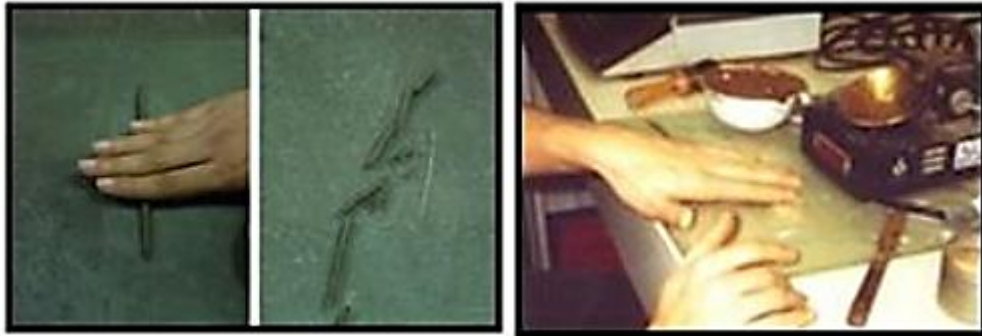
Şekil 4.4. Plastik limit deneyinin yapılışı ( http://www.soiltest.com.tr ).
