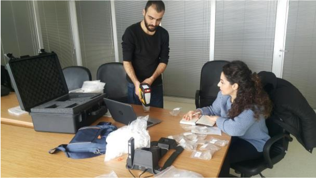
Şekil 3-5: P-XRF spektrometrenin ofis ortamında kullanımı ve bilgisayara veri aktarımı
