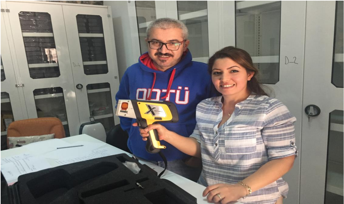
Şekil 3-3: P-XRF spektrometre kullanımı-Diyarbakır Müzesi- Bizans altı çukur sikkelerinin analizi
