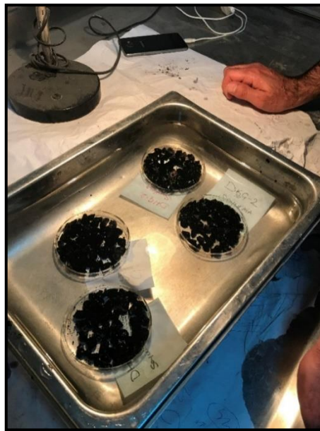
Şekil 3.13. Soyulma oranının ışık yardımıyla gözle incelenmesi
