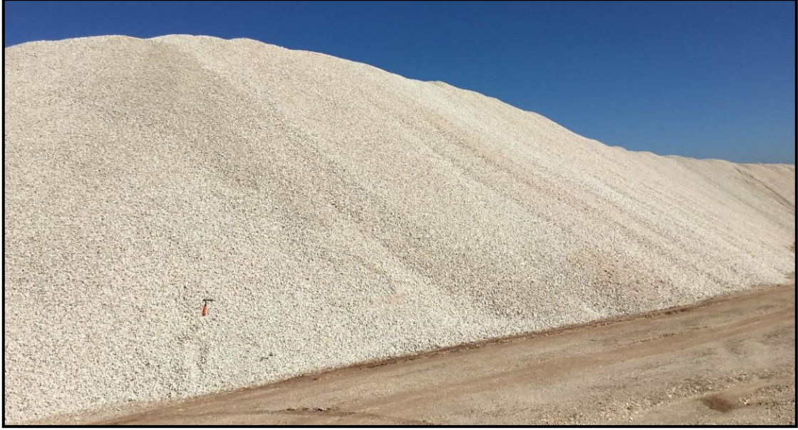
Şekil 6.32. İki köprü (Awiskê) konkasörü (DBK-1)' ne ait 0-38 mm boyutundaki agrega stoğundan uzaktan bir görüntü
