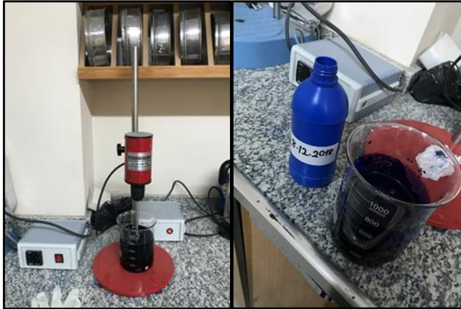
Şekil 3.8. Metilen boya çözeltisinin hazırlanması
