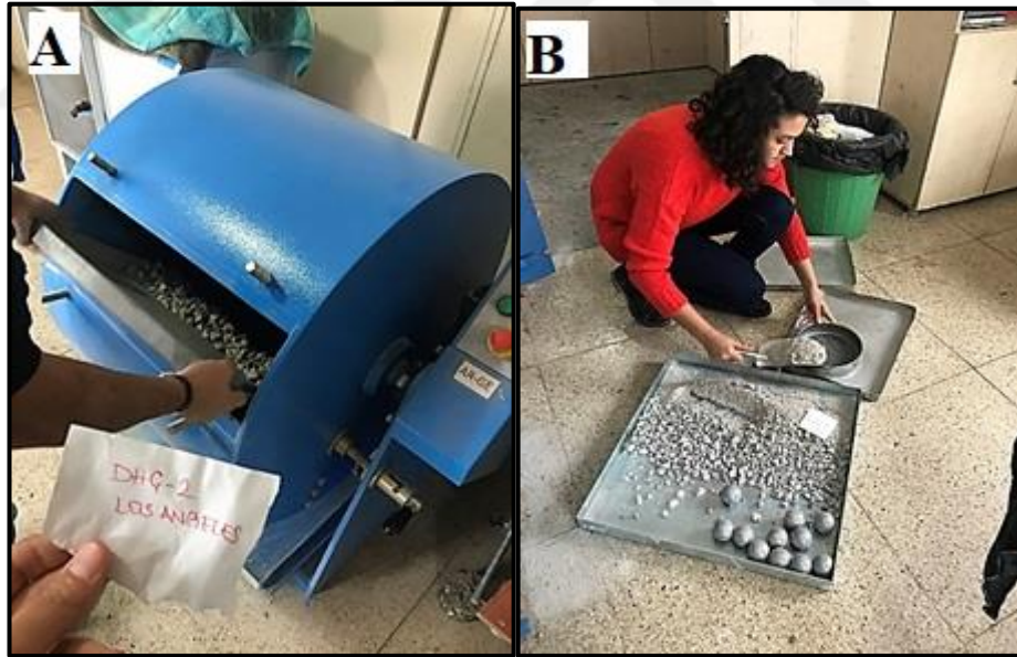
Şekil 3.4. Tambura konulan (A) ve dönme işlemi sonunda 1,6 mm açıklıklı elekten elenen (B) malzeme
