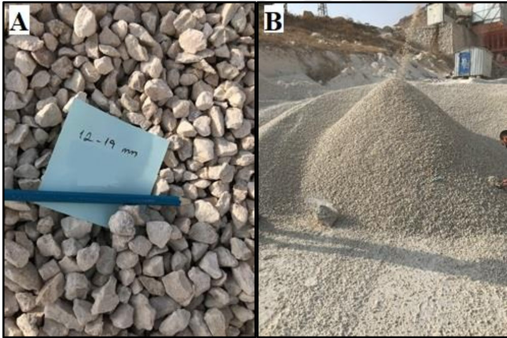
Şekil 6.41. Yeni Hasankeyf konkasörü (DHK-4)' ne ait 12-19 mm boyutundaki agrega (A-yakın stok, B-uzak bant altı)
