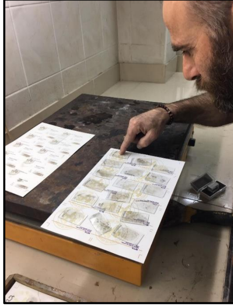
Şekil 3.18. Lama yapıştırma işlemi
