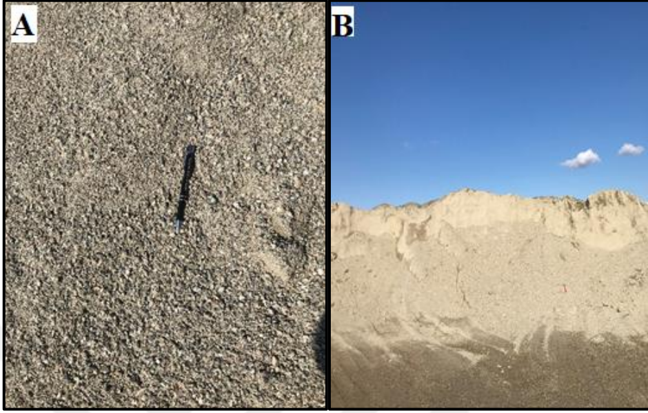
Şekil 6.67. Yediyol (Elkami) konkasörü-2 (DÇ-2)' ye ait 0-5 mm boyutlu agrega stokları (A-yakın, B-uzak)
