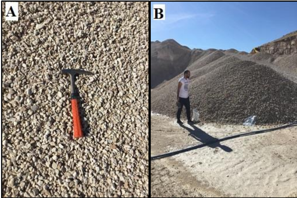
Şekil 6.37. Kuyubaşı (Cegeluye) konkasörü (DHK-1)' ne ait 12-19 mm boyutundaki agrega stoğu (A-yakın, B-uzak)
