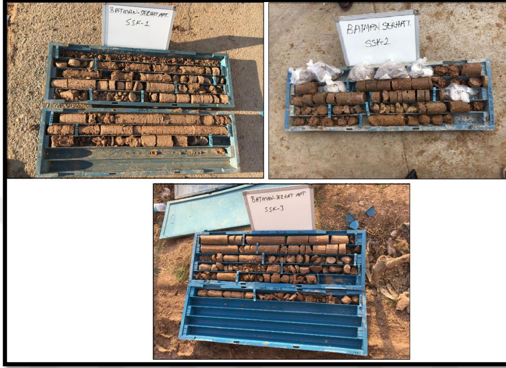
Şekil 5.14. Serhat Apartmanı ve çevresinde açılmış olan SK-1, SK- ve SK-3 numaralı sondaj kuyularından alınan örnekler
