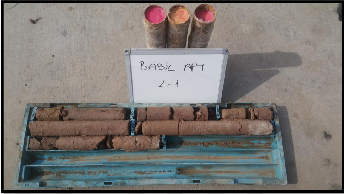
Şekil 5.6. Babil Apartmanında açılan L-1 numaralı sondaj kuyusundan alınan örnekler
