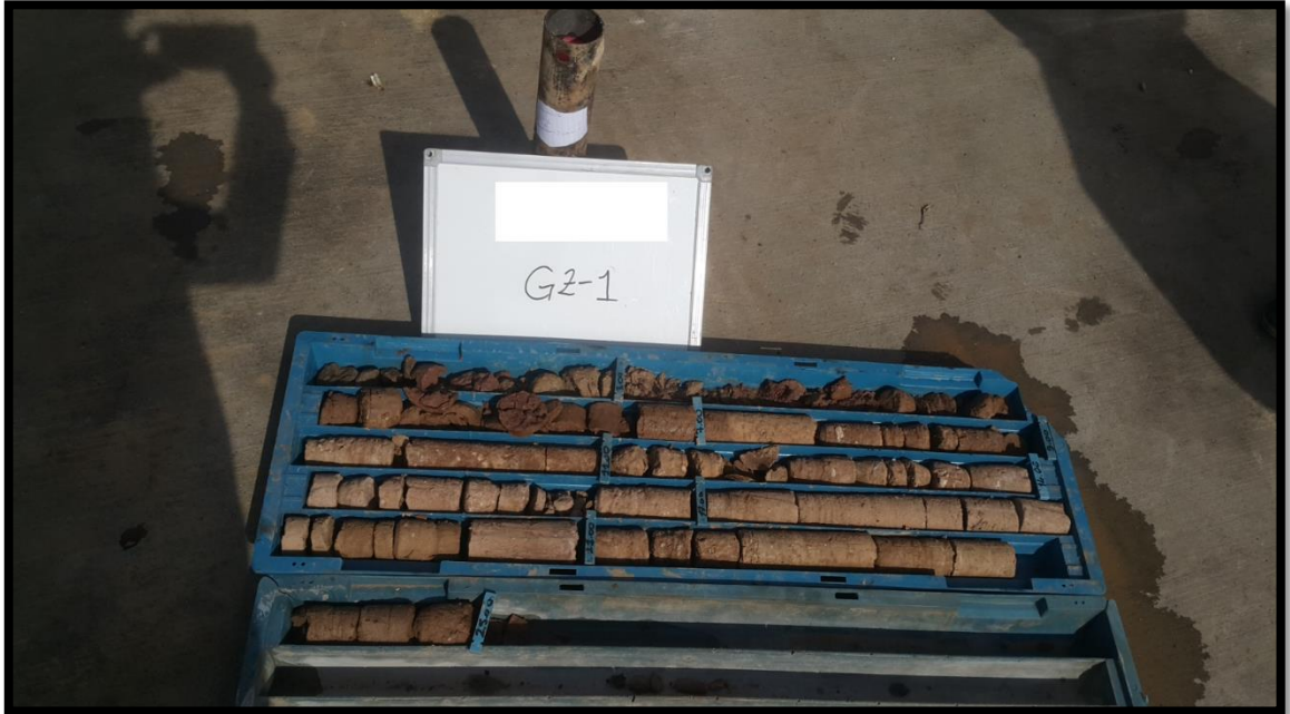
Şekil 5.22. Dünya Hastanesi Doğu tarafında açılan GZ-1 numaralı sondaj kuyusundan alınan örnekler
