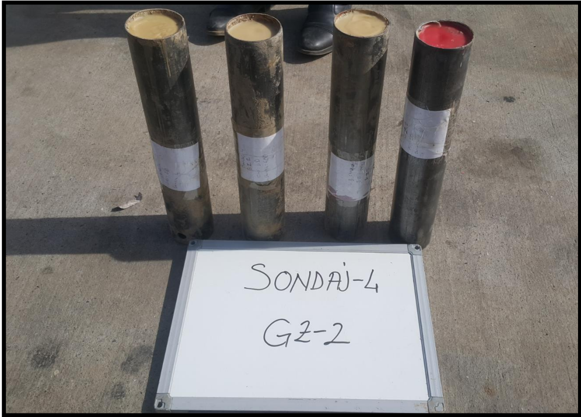
Şekil 5.24. Yaşar Kemal Kent Ormanı alanında açılmış GZ-2 numaralı sondaj kuyusundan alınan örnekler
