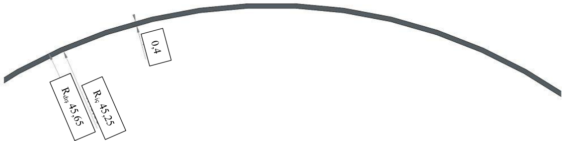
Şekil 3.3. [0/90] 2 Cam – Epoksi' ye Ait Çeyrek Daire Formunda Yamanın Ön Görünüşü
