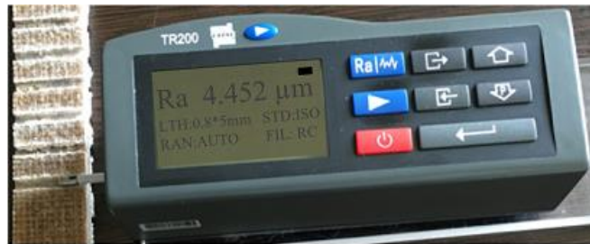
Şekil 3.11. Yüzey pürüzlülük ölçüm cihazı
