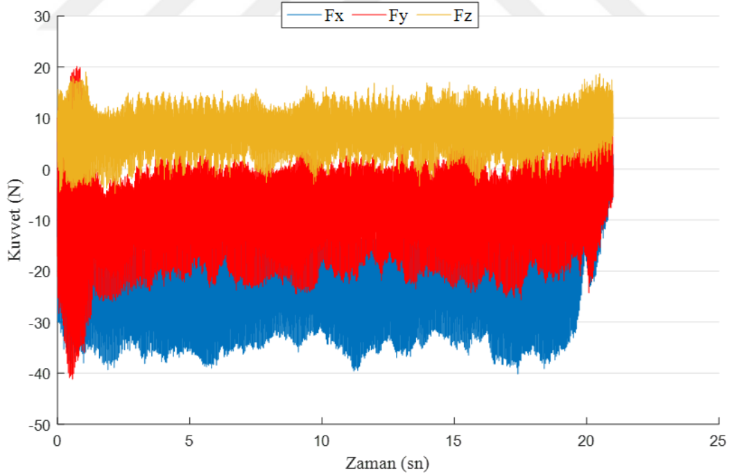
Şekil 32. Kompozit malzeme: KFT, Kesici takım: HSS, Dönme devri: 5000 dev/dak ve İlerleme: 0,015 mm/dev
