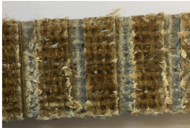
Şekil 4.23. JFTP kompozitin TiN kaplı HSS parmak freze çakısı ile frezelenmesinde oluşan deformasyon görüntüleri
