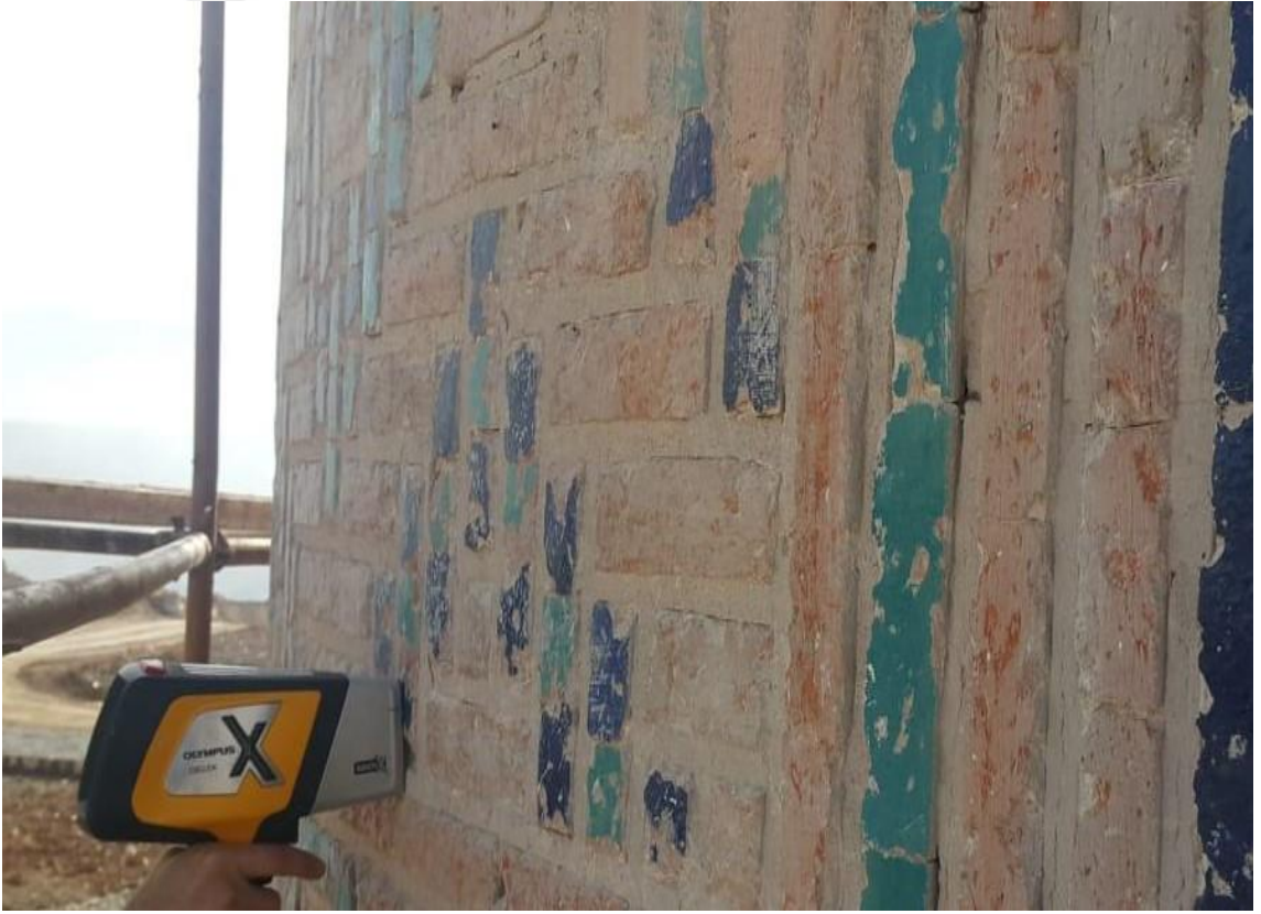
Şekil 7. 2. Zeynel Bey Türbesine ait Koyu Mavi Çinilerin P-XRF cihazı ile analizinin yapılması.
