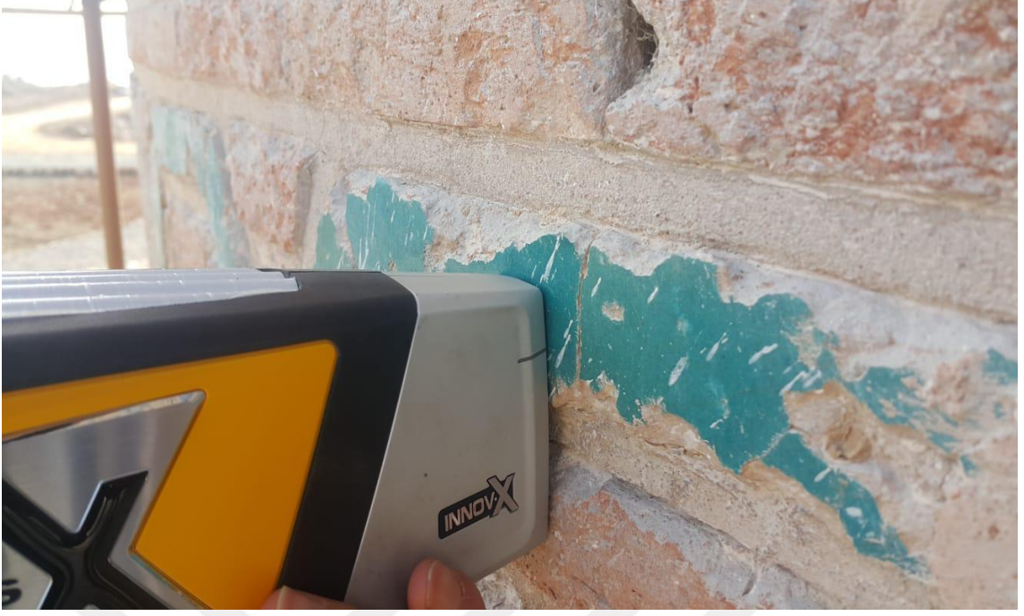
Şekil 7. 1. Zeynel Bey Türbesine ait Açık Mavi Çinilerin P-XRF cihazı ile analizinin yapılması.
