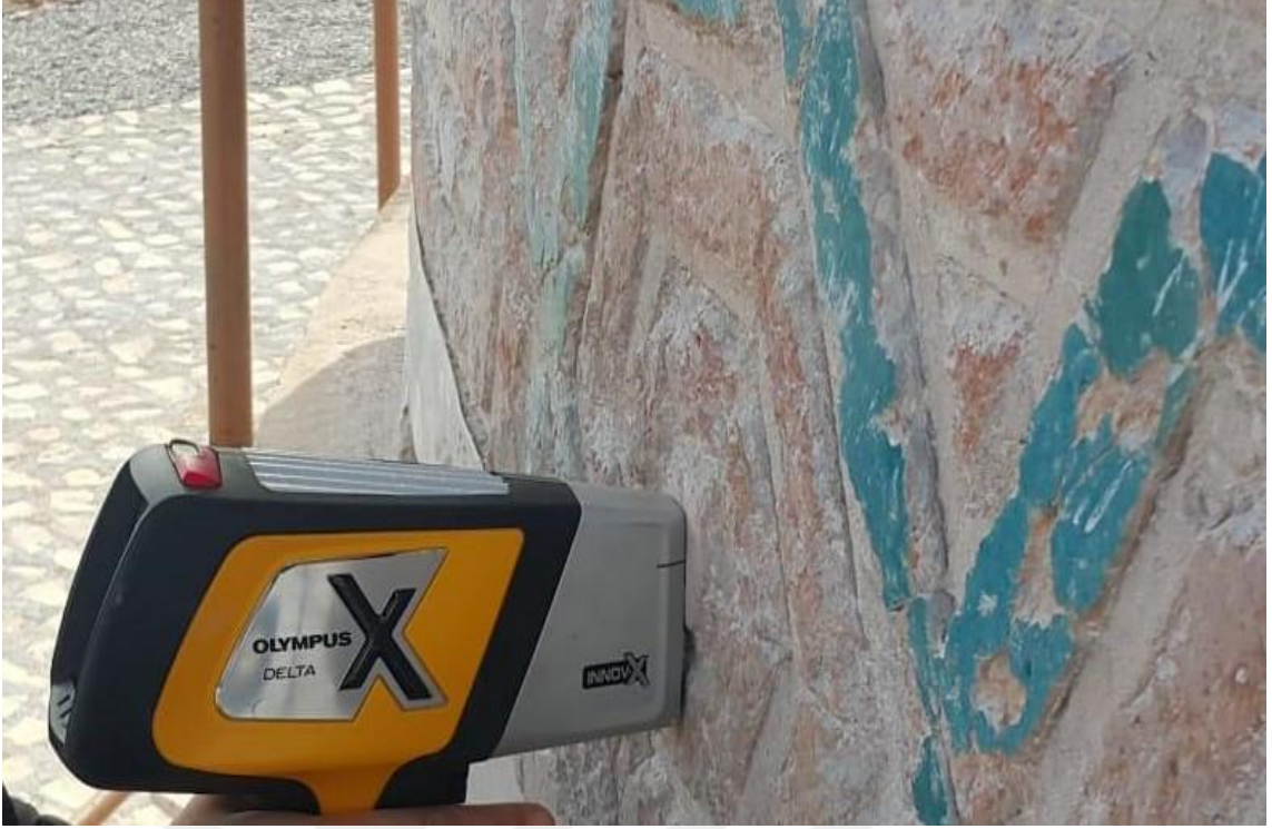
Şekil 7. 3. Zeynel Bey Türbesine ait Sırsız Kiremitlerin P-XRF cihazı ile analizinin yapılması.
