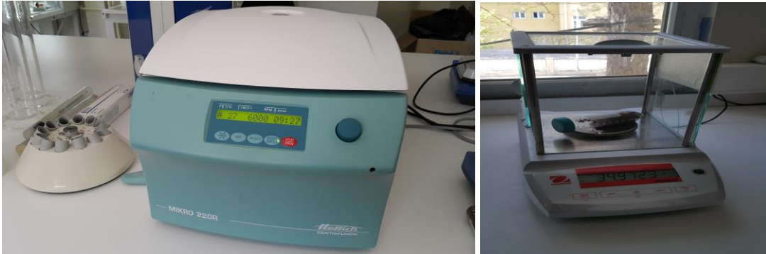
Şekil 3.9. Zeytinyağının çıkarıldığı santrifüj ve tüplerin ölçüldüğü hassas terazi.
