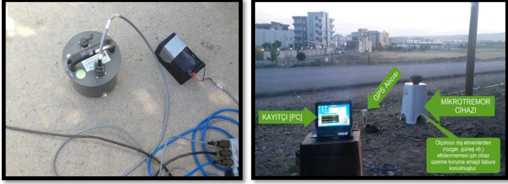
Şekil 3.6 (a) GÜRALP marka CMG-6TD üç bileşen geniş-band hız ölçer sismometre (b) Arazide kurulan sismometre ve ek ekipmanları (Dahili gps anteni, kayıt için pc ve güç için akü)
