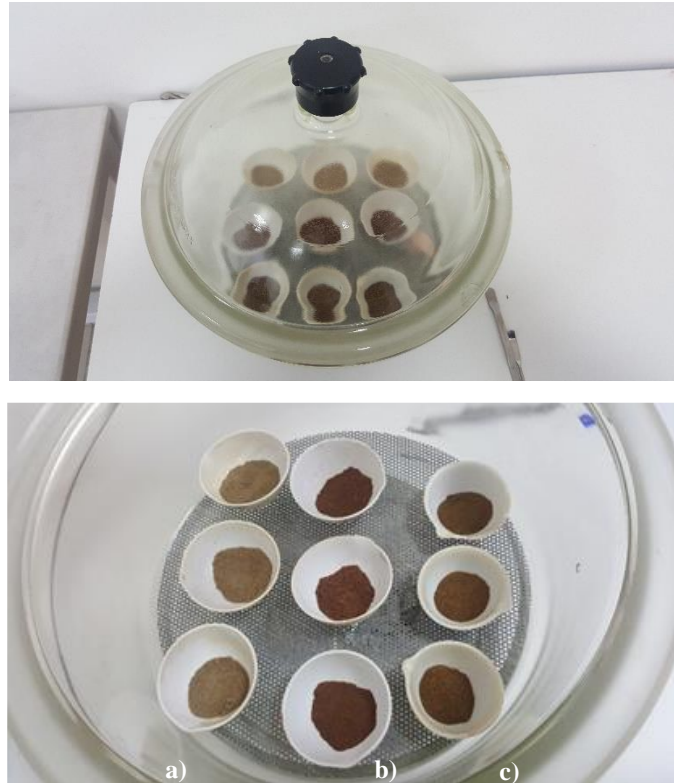
Şekil 3.4. Rutubet miktarının belirlenmesinde kullanılan toz partiküller a) Fıstık kabuğu, b) Fındık kabuğu, c) Kayısı çekirdeği kabuğu
