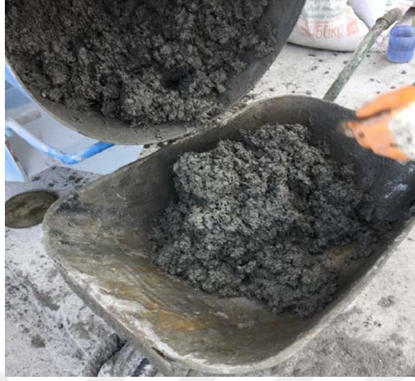
Şekil 3.8. Bazalt agregalı lifli referans betonun (BRLB) karıştırma sonrası görünümü
