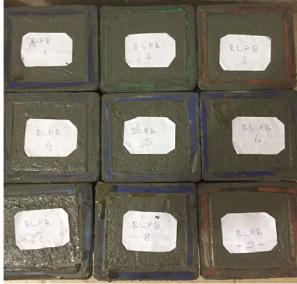
Şekil 3.16. Bazalt agregalı lifli pudra betonun (BLPB) kalıp içerisindeki görünümü
