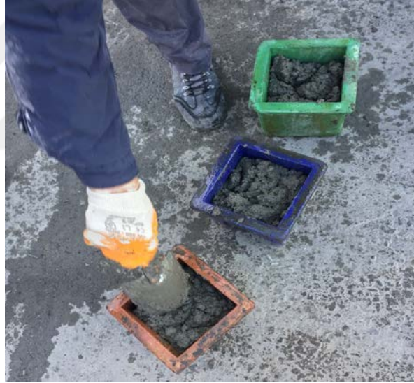
Şekil 3.21. Basınç deney numunelerinin kalıplara yerleştirilmesi
