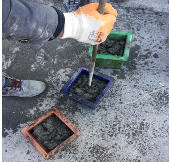
Şekil 3.22. Beton basınç deney numunelerinin kalıp içerisinde sıkıştırılması
