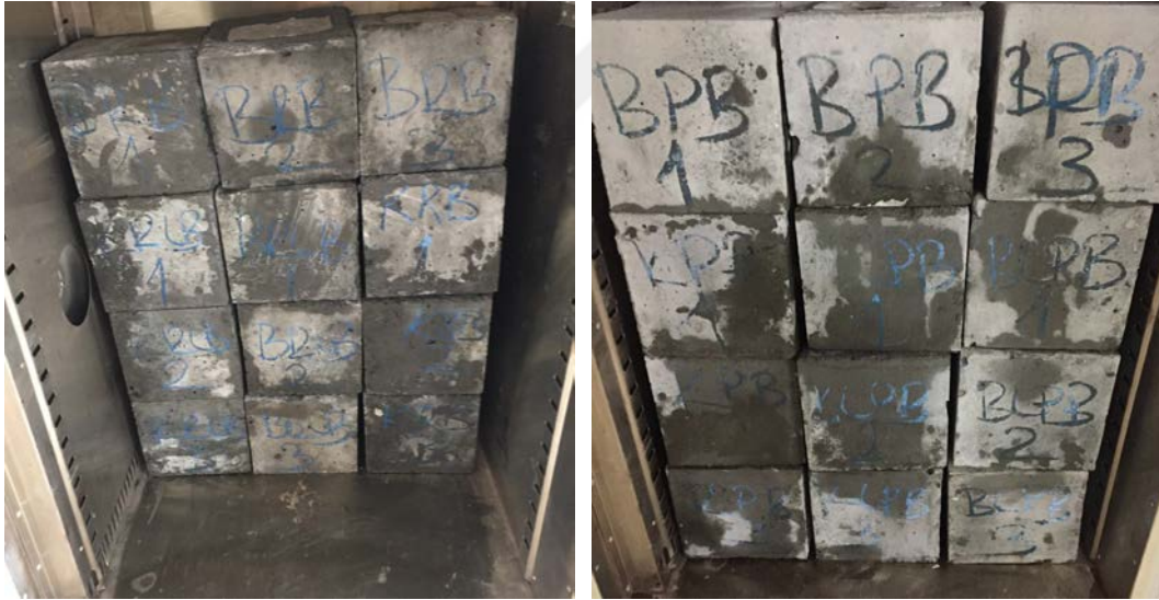
Şekil 3.18. Beton numunelerin etüv içerisindeki görünümü
