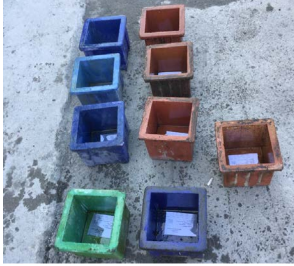
Şekil 3.20. Beton numune kalıp görünümü
