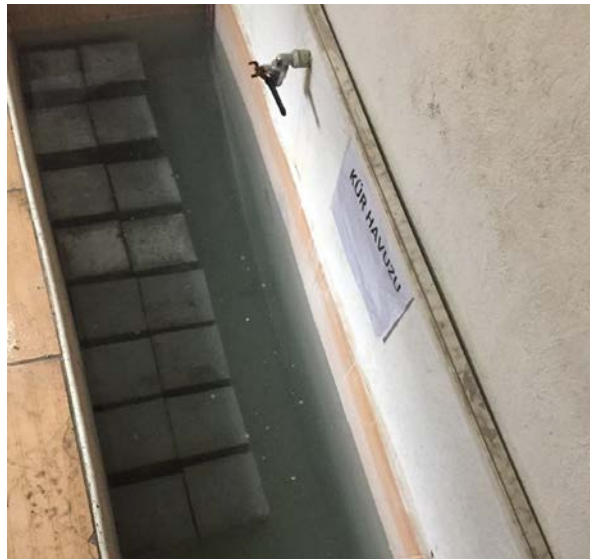
Şekil 3.17. Beton numunelerin kür havuzundaki görünümü
