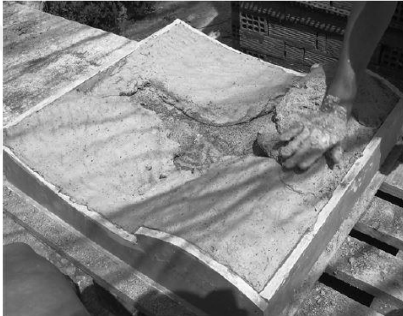
Şekil 2.14. Korinth tipi oluklu kiremit üretim tekniği (Sapirstein, 2009).
