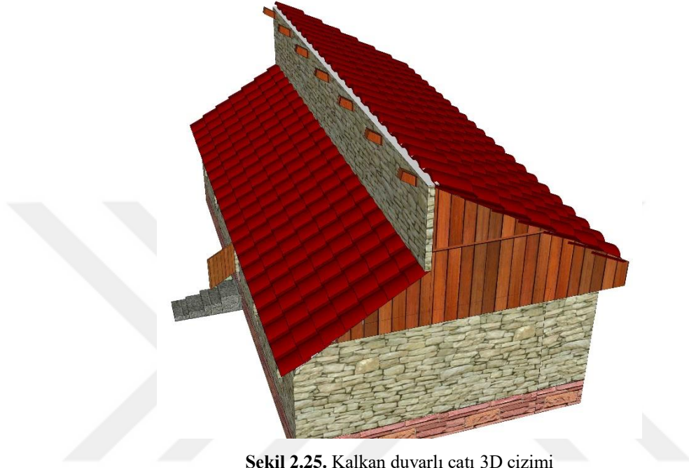
Şekil 2.25. Kalkan duvarlı çatı 3D çizimi
