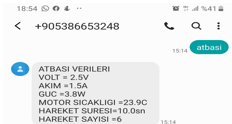
Şekil 6.4. Tanımlı GSM Hattı Üzerinden Uzaktan İzleme (Sayılar İngilizce Formatta)
