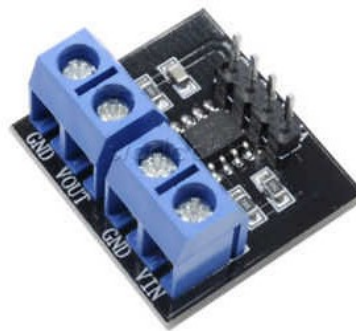
Şekil 5.9. Max471 Voltaj ve Akım Sensör Modülü
