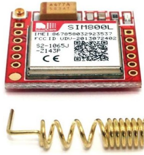
Şekil 5.8. Mini GSM/GPRS Modülü - SIM800L
