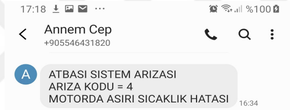
Şekil 6.16. Tanımlı GSM Hattı Üzerinden Hata Kodu 4 Aşırı Sıcaklık Hatası Uyarısı
