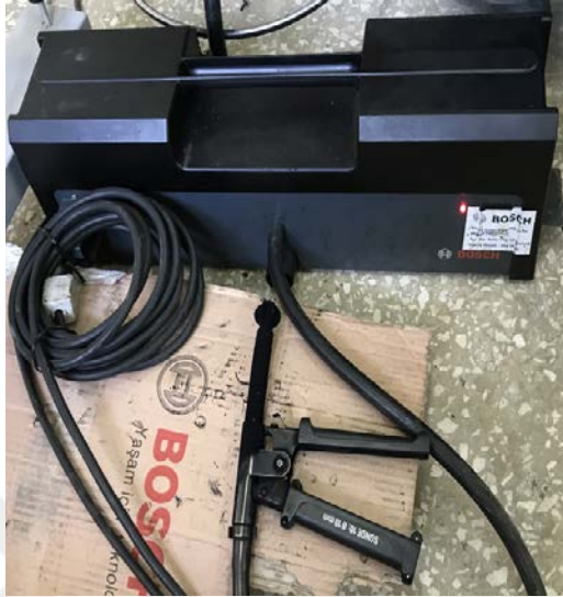
Şekil 3.12. Egzoz gazı duman koyuluđu ölçüm cihazı
