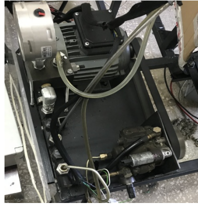
Şekil 3.6. Common-Rail yakıt sistemi
