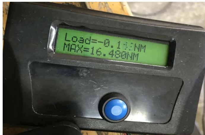
Őekil 3.9. Dinamometre yk gstergesi
