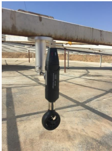
Şekil 3.22. Kolektör ağız girişindeki hava hızı ölçümü
