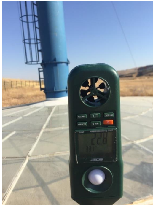
Şekil 3.24. Sistemin nem, hava hızı ve sıcaklık ölçümleri
