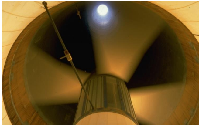
Şekil 2.3. Manzaranes prototipinde kullanılan türbin (Zhou ve ark. 2010)
