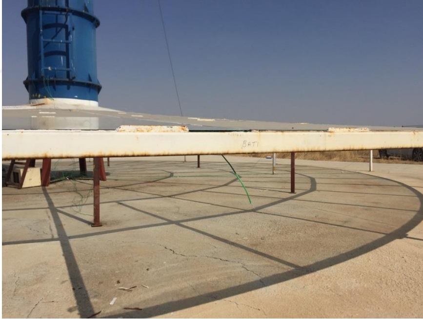
Şekil 3.15. Kolektör giriş ağzındaki sıcaklık ölçümü
