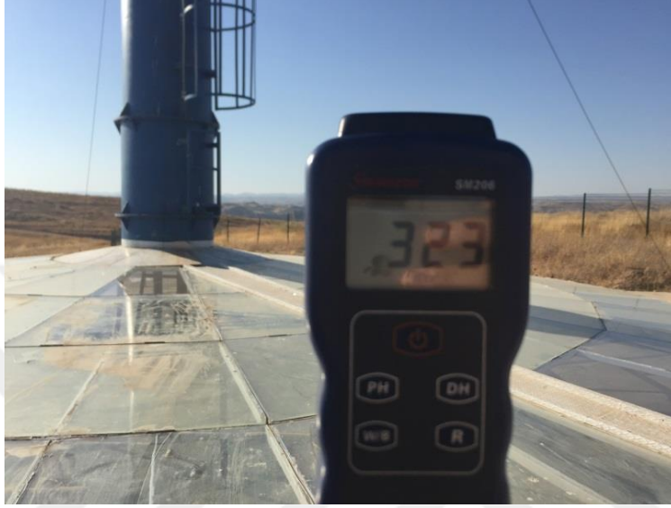
Şekil 3.23. Prototip üzerine gelen anlık ışınım miktarı ölçümü
