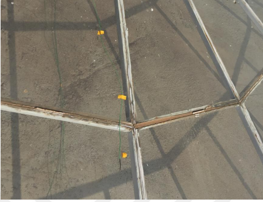
Şekil 3.16. Kolektör üst yüzeyi sıcaklık ölçümü
