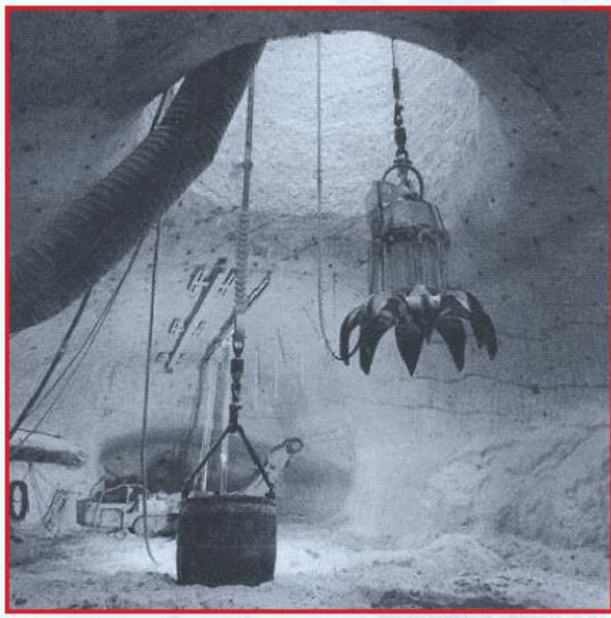
Şekil 3.13.Döner pnömatik cactus yükleme sistemi (Köse ve ark.,1992)
