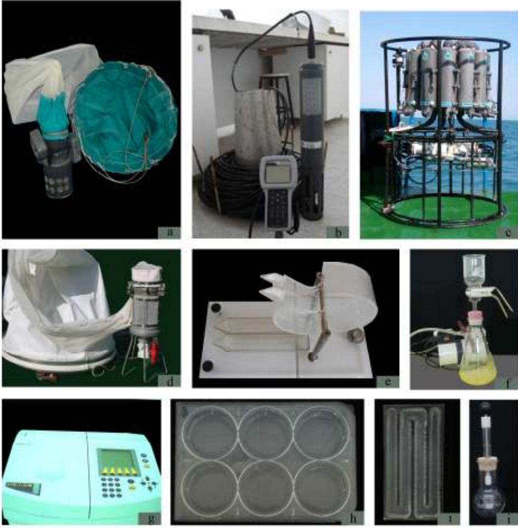
Şekil 4.2. Plankton örnekleme ve sayımında kullanılan araç-gereçler. a: Standart tip plankton kepçesi, b: YSI 6600 marka su kalitesi ölçüm sondası, c: SeaBird CTD sensor, d: Nansen tipi plankton kepçesi, e: Folsom ayırıcısı, f: milipor, g: spektrofotometre, h: doku kültür kabı, ı: Sayım kamarası, i: Stempel pipet (Orijinal)
