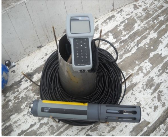
Şekil 4.13. Deniz suyu sıcaklık ve tuzluluk ölçümünde kullanılan YSI 6600 cihazı (Orijinal)
