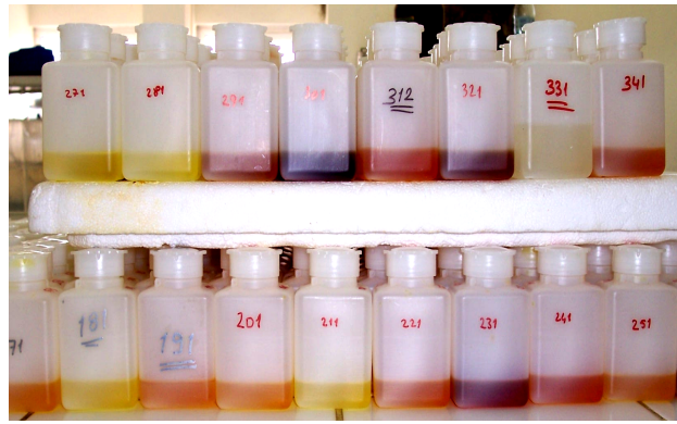
Şekil 3.2.5.3.1. Yakma sonrası sıvı hale getirilmiş ve polietilen şişelere konulmuş örnekler (Türk Çulha, 2007)
