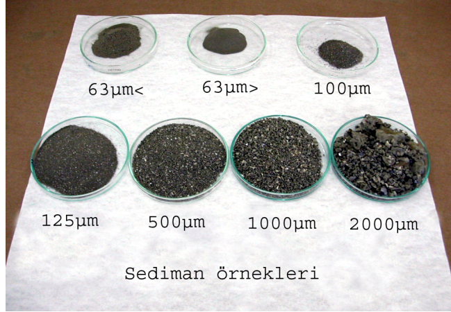
Şekil 3.2.3.1. Elek serisinden geçirilmiş ve sınıflandırılmış sediment örnekleri (Türk Çulha, 2007)
