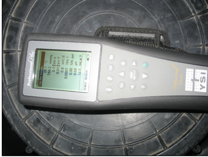
Şekil 4.6. YSI Professional Plus su parametreleri ölçüm cihazı
