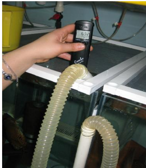
Şekil 4.7. Su parametre (iletkenlik, pH, sıcaklık, Tds) ölçüm cihazı (Orijinal)
