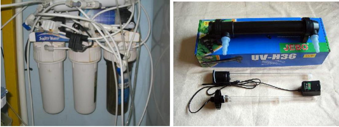
Şekil 4.6. Sistemde kullanılan Ters Ozmos Cihazı (solda) ve UV Filtre (sağda) (Orijinal)
