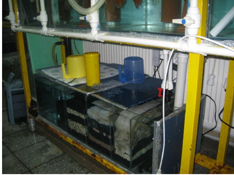
řekil 4.4. Filtre tankı (sump) (Orijinal)
