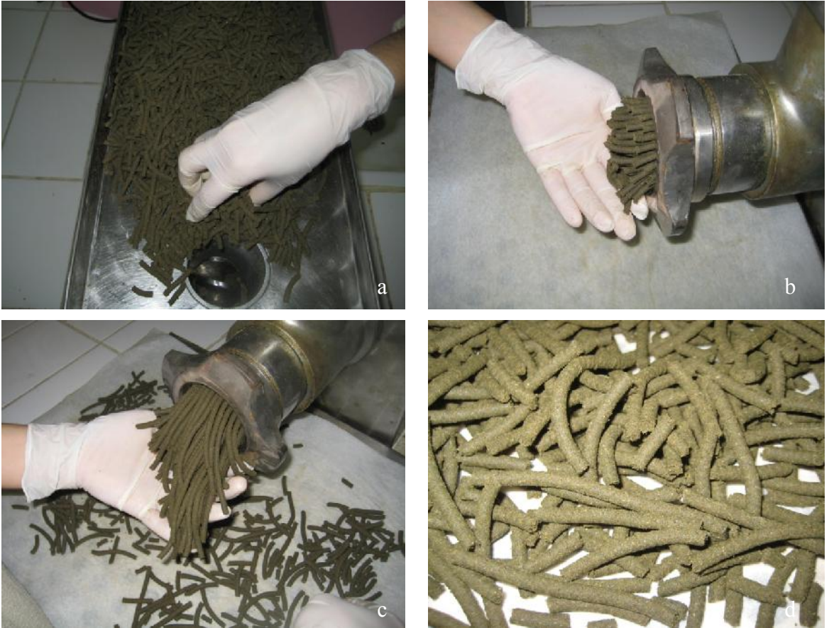
Şekil 3.2.3.3. a) Yem karmasının kıyma makinesinden geçirilmesi, b) Yemlerin kıyma makinesinden pelet halinde çıkarılması, c) Makineden çıkan peletlerin tepsilere alınması, d) 3 mm çapındaki peletler (Orijinal)
