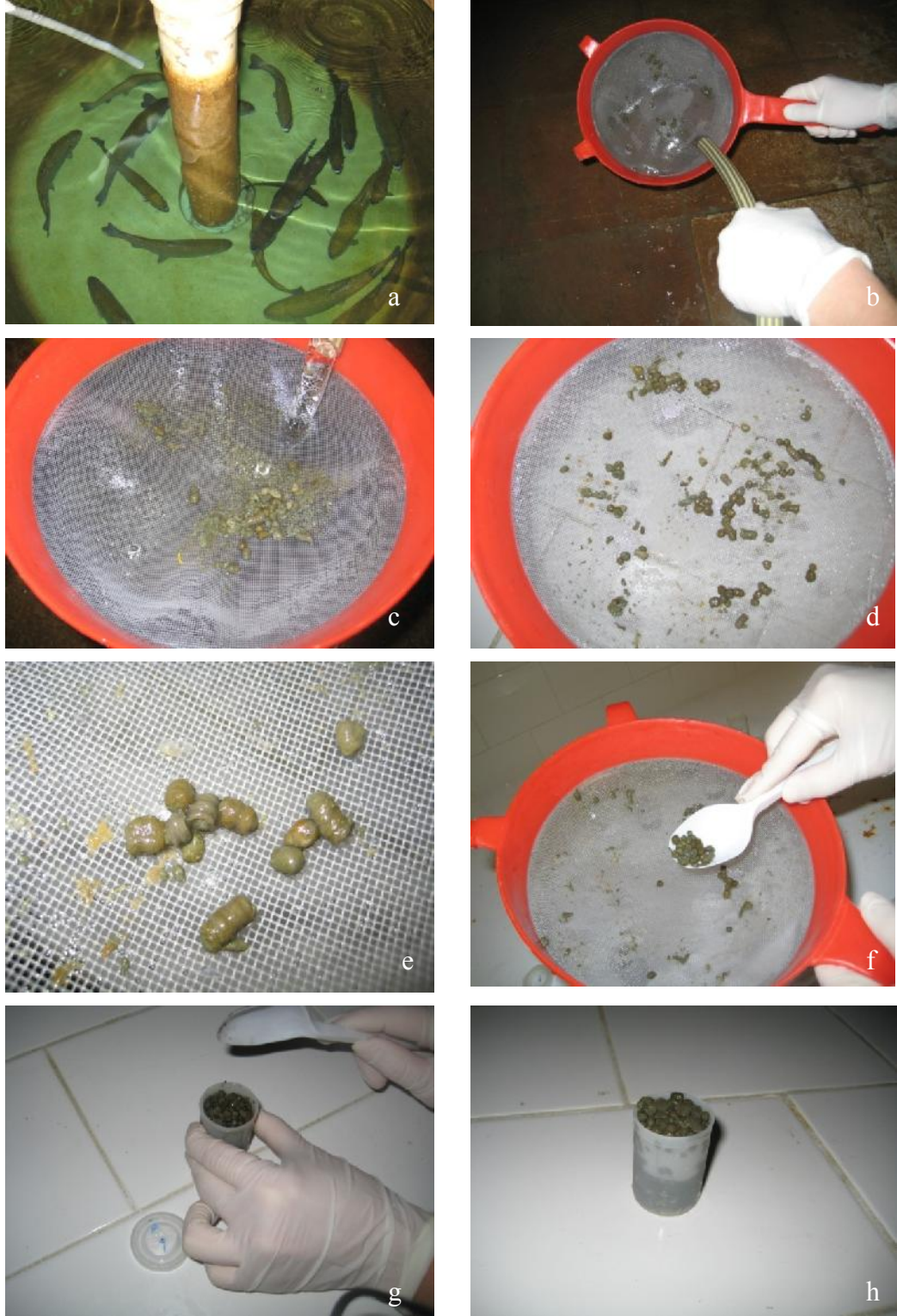
Şekil 3.2.5.1. a) Sifonlama tekniği ile dışkıların tanklardan toplanması, b), c) Dışkıların süzgeç üzerine alınması, d) Dışkıların suyunun süzülmesi, e) Dışkıların genel görünümü, f) Dışkıların süzgeç üzerinden alınması, g) Dışkıların numune kaplarına konulması, h) Numune kabına konulan dışkıların görünümü (Orijinal)
