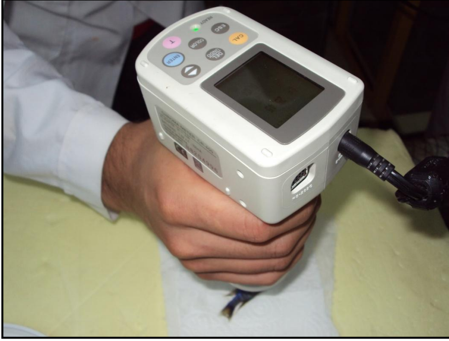
Şekil 4.2.4.2.Kolorimetre ile balık derisinde fiziksel renk analizinin yapılması (Orijinal)
