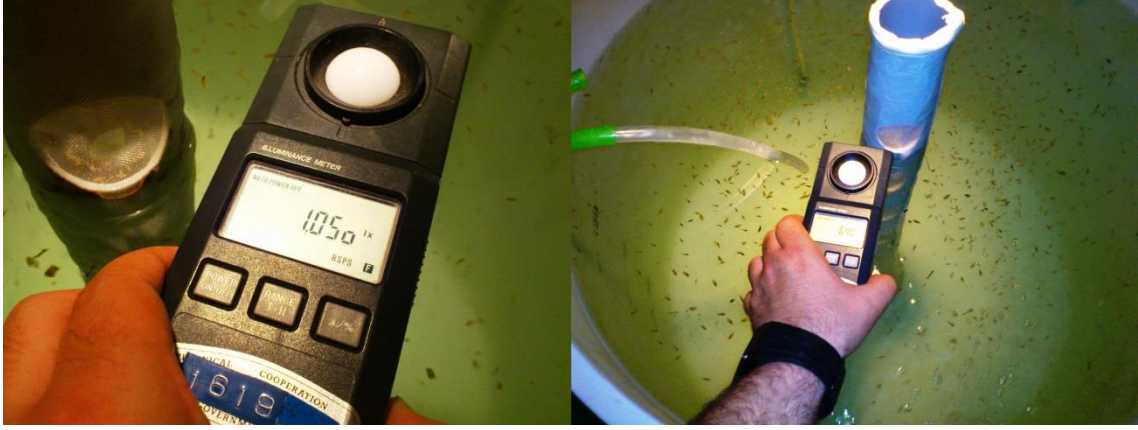
Şekil 4.24. Işık şiddetlerinin ölçümü (Orijinal)
