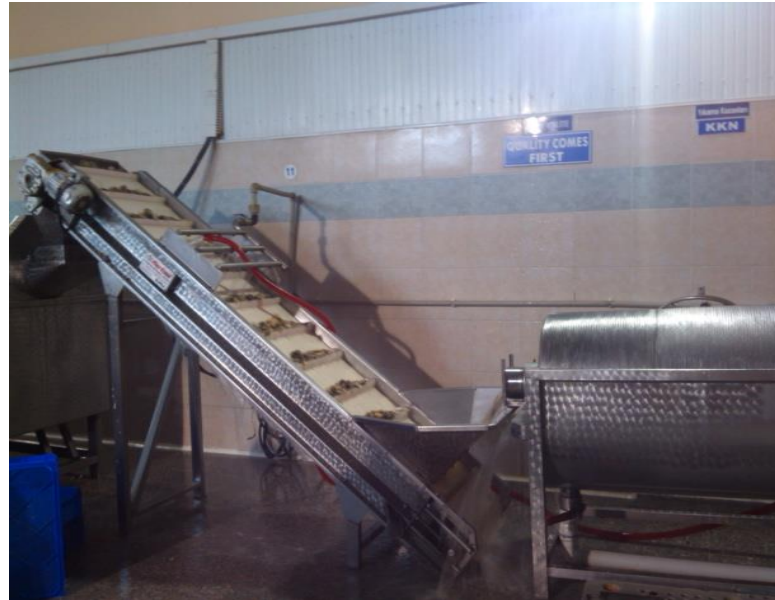
Şekil 4.1.7. Yıkama işleminden sonra etlerin elevatörle kalibre makinesine taşınması (Orijinal)
