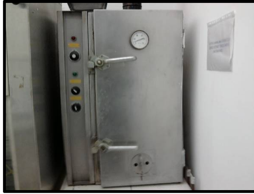
Şekil 3.1.4.1.a. Yarı mekanik dumanlama fırını (orijinal).
