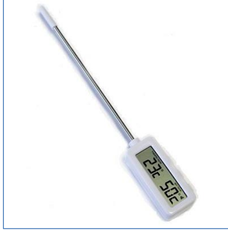
Şekil 3.1.5.8.1. Denemede erime ve jelleşme sıcaklığı analizlerinde kullanılan hassas termometre (Anonim, 2015aa)
