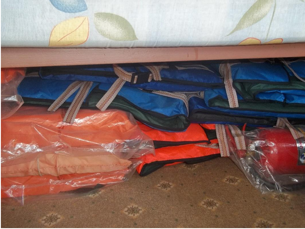
Şekil 5.1.2.4. Teknede ulaşımı zor olan kaptan köşküne depolanmış ve aktif olarak kullanılmayan can yelekleri (Orijinal)
