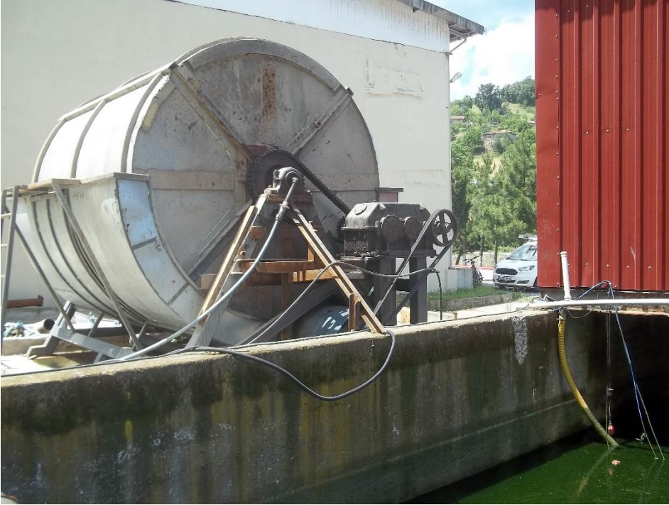
Şekil 5.1.3.5. Ağ yıkama makinasının açığta duran kasnak ve kayışları (Orijinal)
