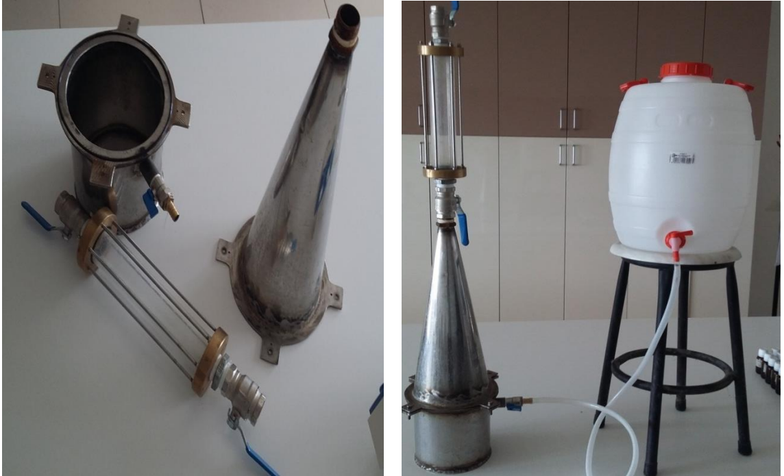
Şekil 3.23. Yoğunluk ayırıştırma düzeneği
