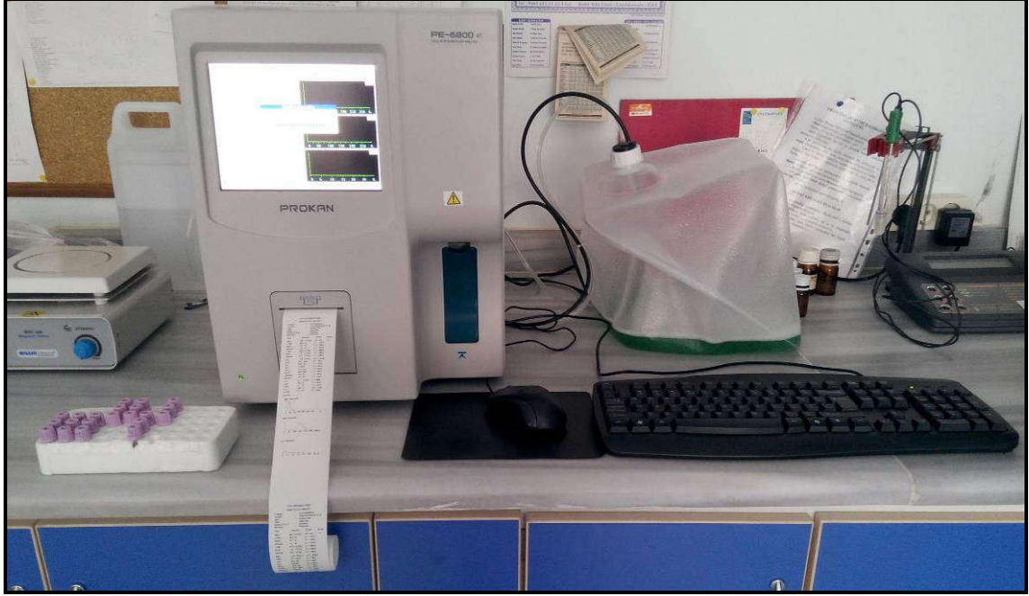
Şekil 3.2.7.2.1. Balık kanında hematolojik analizlerde kullanılan PE-6800 VET tam otomatik hematoloji analiz cihazı ve analiz sonuçlarının otomatik olarak alındığı kâğıt (Orijinal)
