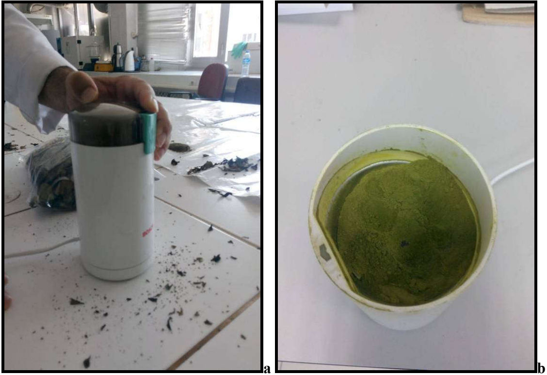
Şekil 3.2.1.14. 90°C sıcaklığa ayarlanmış fanlı etüvde 30 dakikada kurutulmuş yeşil çay yaprağının BOSH marka 180 W'lık kahve değirmeninde öğütülmesi (a) ile öğütülmüş (b) hali (Orijinal)
