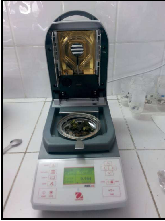
Şekil 3.2.1.6. Kurutulmuş çay yaprağı neminin ölçüldüğü DHAUS MB45 marka nem cihazı (Orijinal)
