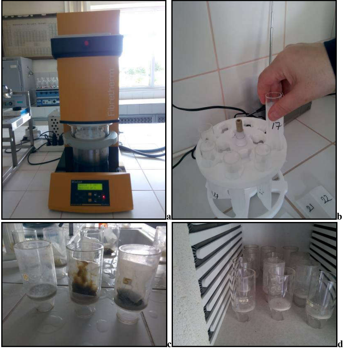
Şekil 3.2.4.5.1. Selüloz tayininin yapıldığı Gerhart marka tam otomatik selüloz tayin cihazı (a), fiberbaglerin cihaza yerleştirildiği düzenek (b), süzme krozelerin (c) ve süzme krozelerin kül fırınında yandıktan sonraki görünümü (d) (Orijinal)
