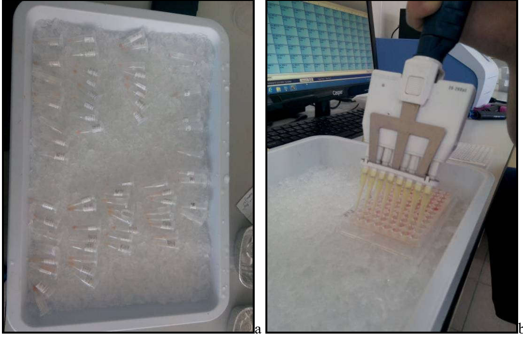
Şekil 3.2.7.1.2. İçerisinde buz bulunan bir küvette (a) kan serumu örneklerinin analiz için çözdürülmesi ve çözünen kan serumu örneklerinin analize hazır hale getirilmesi (b) (Orijinal)
