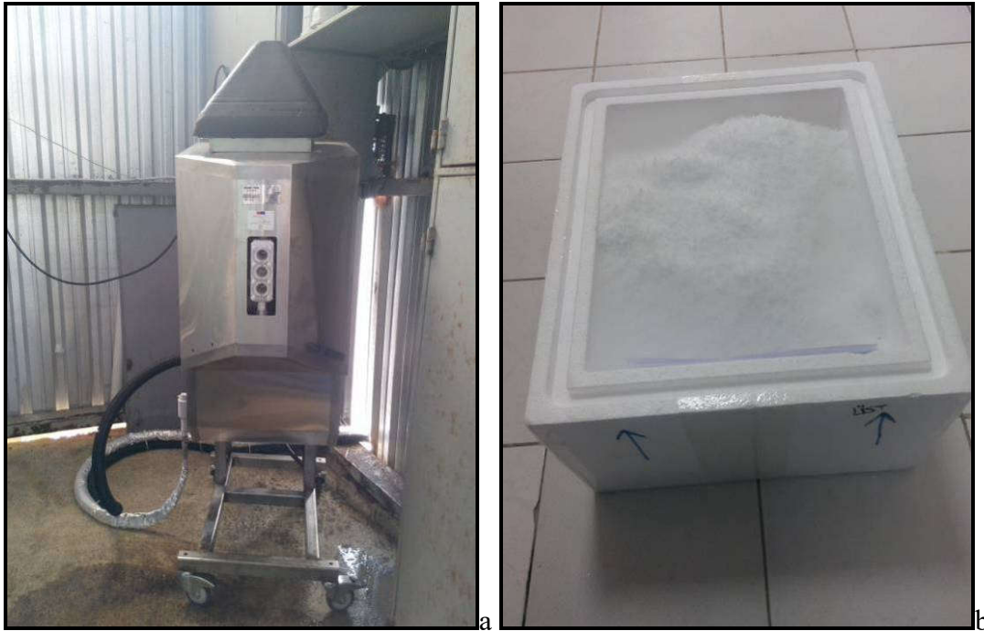
Şekil 3.2.7.1.1. Balık kanlarının sağlıklı bir şekilde nakliyesi için kullanılan kuru buz makinesi (a) ve elde edilen kuru buz (b) (Orijinal)
