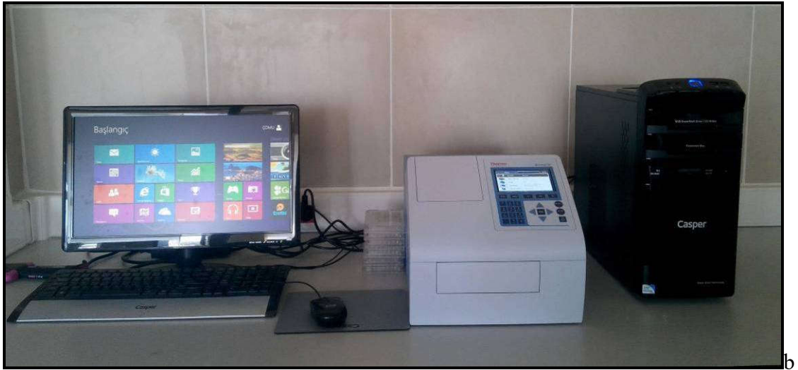
Şekil 3.2.7.1.3. Kan serumundaki, toplam protein, albumin, glukoz, kolesterol ve trigliserid analizleri için (8×12) 96'lık kuyucuklu plaka içerisine konulmuş kan serumu örneklerinin eklenen kitlerin rengini almış hali (a) ve analizlerin yapıldığı Thermo marka (Multiskan™ GO Microplate Spectrophotometer) elisa cihazı (b) (Orijinal)
