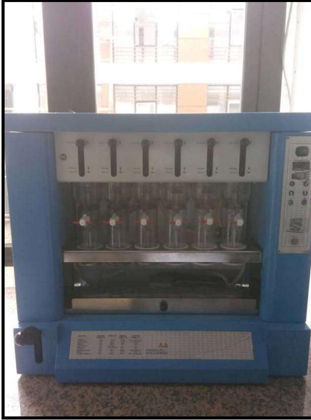
Şekil 3.2.4.3.1. Ham yağ tayininin yapıldığı yağ tayin cihazı (Orijinal)
