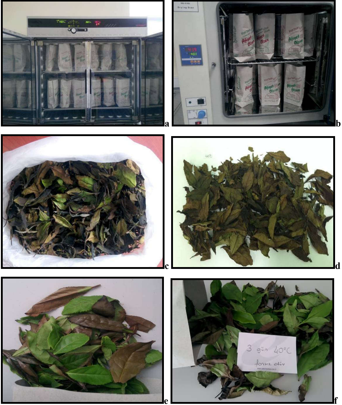
Şekil 3.2.1.3. 40°C sıcaklığa ayarlanmış fansız (a) ve fanlı (b) nitelikteki 2 etüve yerleştirilmiş çay içeren kese kağıtları. 1. girişim sonunda fanlı etüve konulan çayın 45 saat sonraki görünümü (c, d) ile fansız etüve konulan çayın 65 saat sonraki (e,f) görünümleri (Orijinal)
