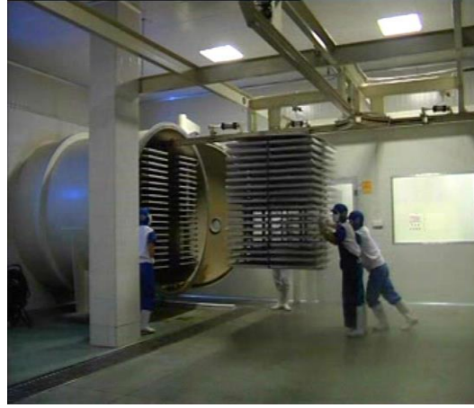
Şekil 4.5.2.4.1. Tünel tipi dondurarak kurutucular (Anonim, 2016h)
