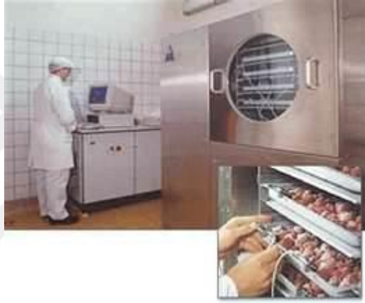
Şekil 4.5.1.1. Pilot ölçekli dondurarak kurutucu (Anonim, 2016c)
