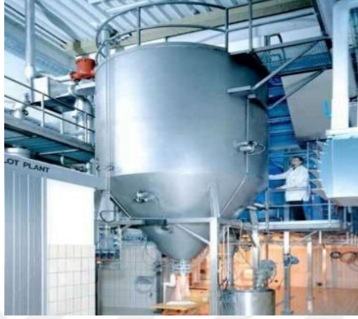
Şekil 4.5.2.3.1. Vakum sprey dondurarak kurutucu (Anonim, 2016g)
