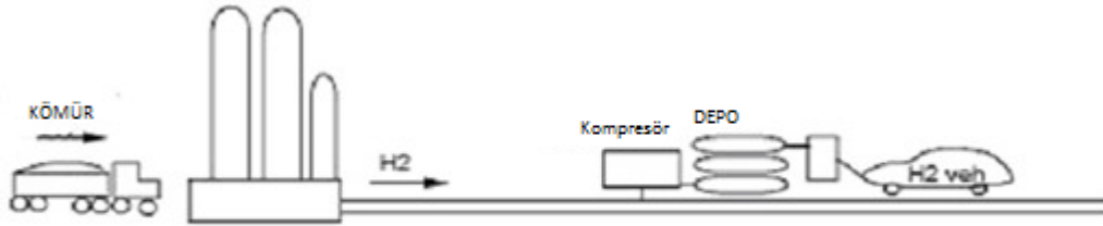
Şekil 2.4. Kömür Gazlaştırılması İşlemi
