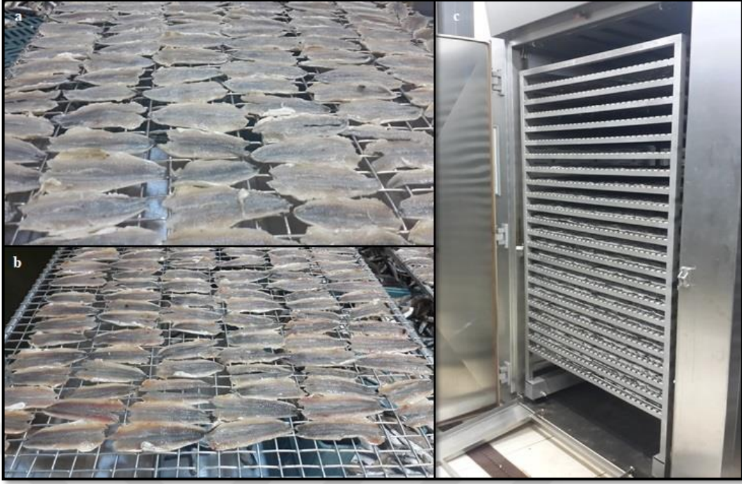
Şekil 4.4. a: Marine edilmiş hamsilerin sıcak dumanlama öncesi ızgaralara dizilmesi, b: Marine edilmiş hamsilerin soğuk dumanlama öncesi ızgaralara dizilmesi, c: Dumanlama işlemi (Orijinal).
