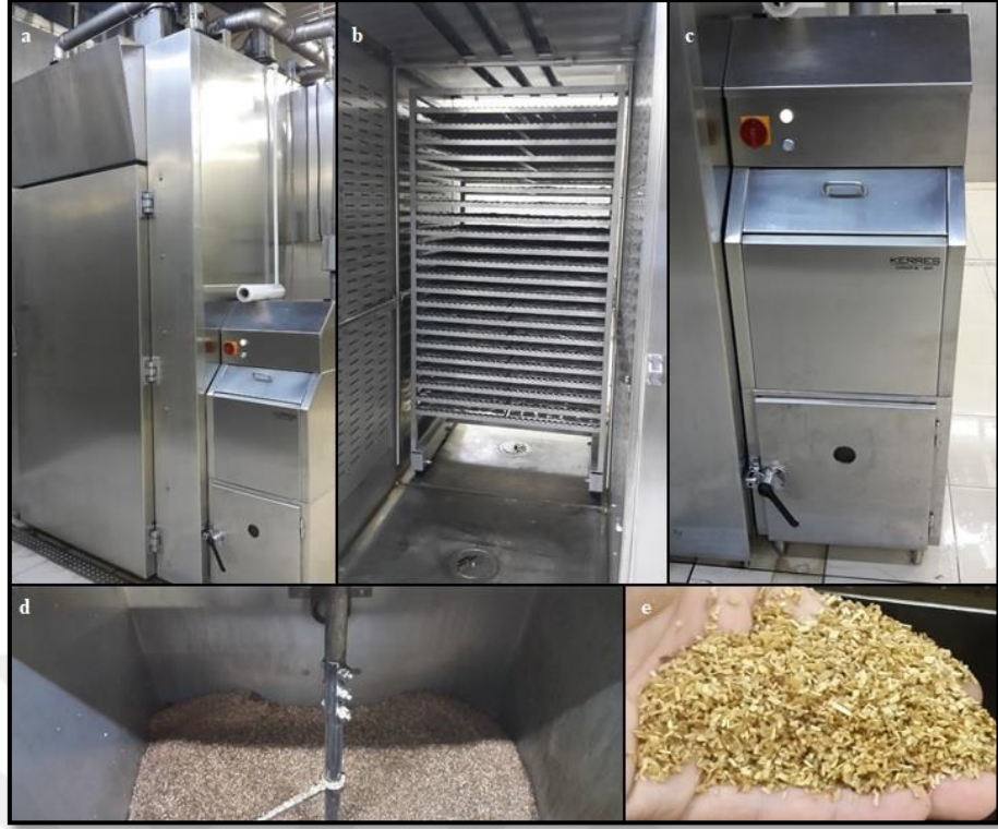
Şekil 4.9. a: Çalışmada kullanılan tütsüleme fırını, b: Dumanlama fırınının içten görünümü, c: Talaş ünitesi, d: Talaş ünitesinin içten görünümü, e: Meşe ağacı talaşı (Orijinal).
