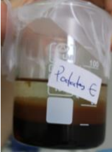
Şekil 3. 7 Elektrokimyasal yöntem ile patates atık kızartma yağından elde edilen metil ester ve gliserin fazları
